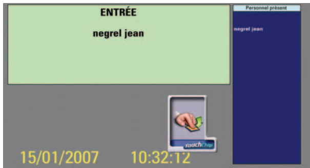
Figure 8 : Au moment de l'accès, l'utilisateur doit simplement apposer son doigt sur le lecteur d'empreintes digitales et son nom apparaît dans la liste des personnes présentes.
