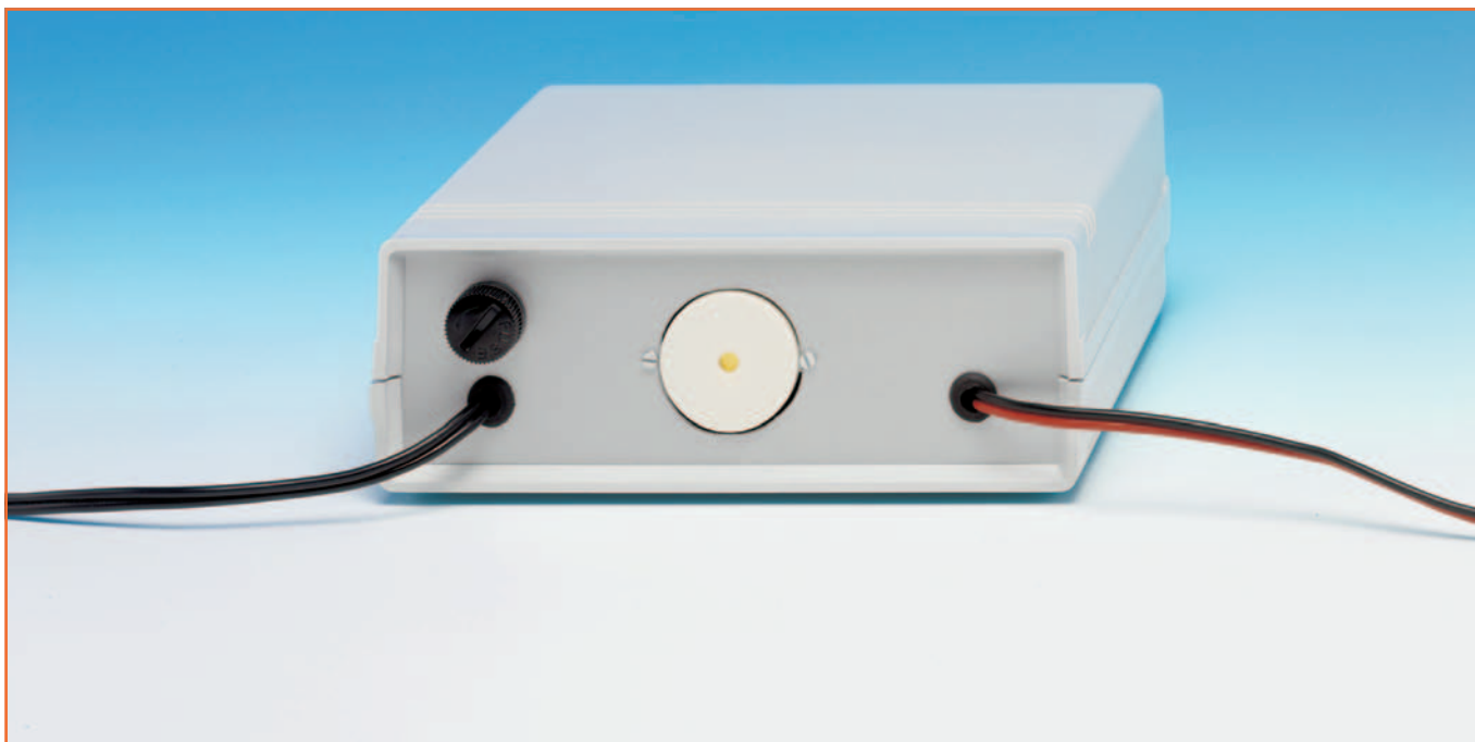
Figure 8: Photo d'un des prototypes de l'appareil complet prêt à fonctionner, vu de derrière. Le porte-fusible et le cordon secteur à gauche, le buzzer au centre et à droite le câble relié au relais.
