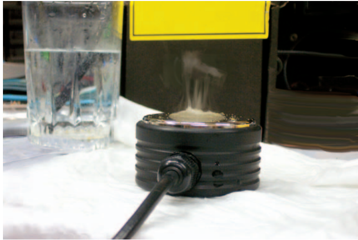
Figure 21: Pour vérifier le fonctionnement correct du diffuseur, quand le générateur est éteint, mettez quelques gouttes d'eau sur le diffuseur, puis allumez le générateur et pressez le poussoir START/PAUSE. Si tout fonctionne bien, vous verrez de la vapeur d'eau s'élever du diffuseur. Éteignez l'appareil avant que toute l'eau ne soit vaporisée.
