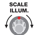
Figure 7: Le bouton "SCALE ILLUM." est utilisé seulement pour illuminer le réticule de l'écran afin de mieux visualiser la position occupée par le signal.
