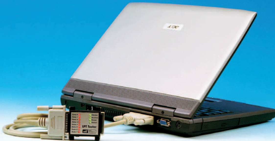
Figure 7 : Le testeur de LPT est relié au port parallèle (Line Printer) de l'ordinateur avec un câble à 25 pôles pin to pin mâle / femelle.
