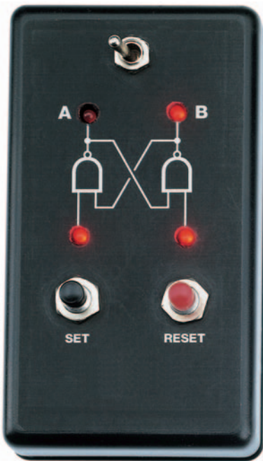
Figure 554 : Le circuit de la figure 553 est protégé par un boîtier plastique de petites dimensions sur lequel on collera l'étiquette auto-collante constituant, avec le couvercle, la face avant.
