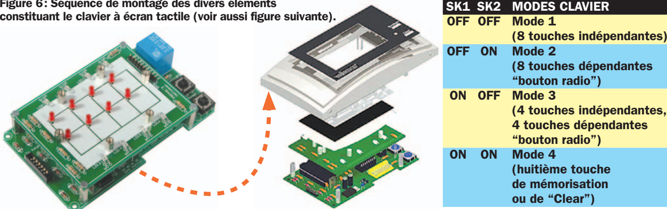
Figure 7 : Séquence détaillée de montage du clavier.
