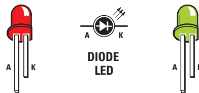
Figure 2: Brochages du circuit intégré 40106 vu de dessus et des LED vues en contre-plongée.
