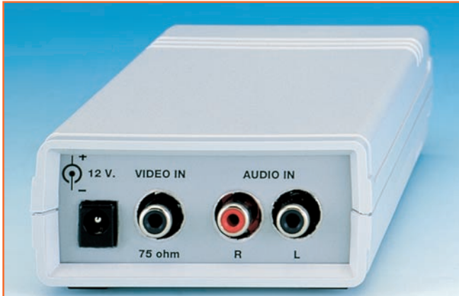
Figure 2: Panneau arrière de l'émetteur audio/vidéo. La prise d'alimentation reçoit le jack de l'alimentation 12 V externe (voir figure 7a) et les RCA "cinch" permettent l'entrée des signaux vidéo et audio.
