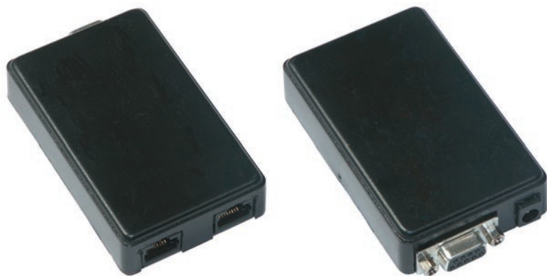
Figure 7 : L'installation dans le boîtier de l'interface de communication. D'un côté les deux ports en parallèle entre eux RJ45 utilisés pour relier les lecteurs de transpondeurs, de l'autre un port sériel au format RS232 avec lequel se fait la liaison à un ordinateur. Un jack pour l'alimentation en 16 V environ est également présent.
