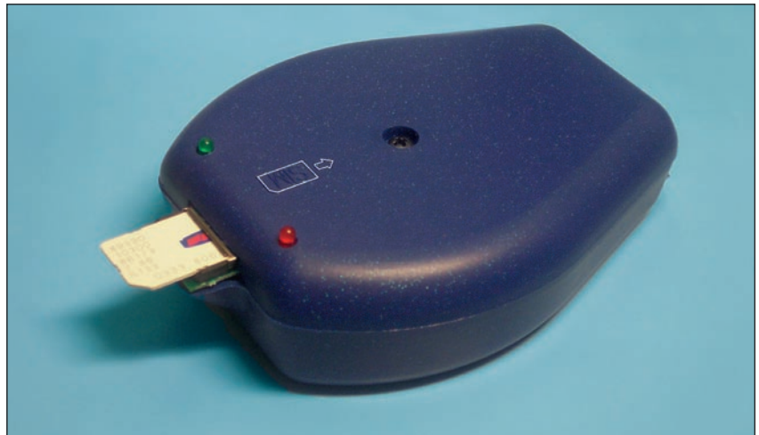
Figure 11: La carte SIM est à enfiler dans la fente du lecteur, pistes vers le bas et pan coupé en bas à droite. Si vous ne l'enfilez pas correctement, le message de la figure 15 apparaît à l'écran.
