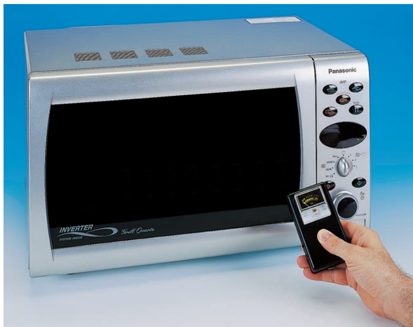
Figure 1: Pour voir si votre four à micro-ondes présente des fuites de SHF, vous devez déplacer le détecteur le long du périmètre de la porte, en face des charnières et de la garniture.
