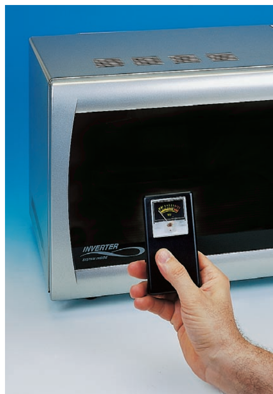
Figure 7 : En théorie, les ondes SHF utilisées dans les fours à micro-ondes ne devraient jamais sortir à l'extérieur, mais si vous approchez le détecteur de fuites, vous pourrez le vérifier par vous-même. Si vous placez le détecteur à environ 20 cm du four, l'aiguille ne devrait pas dévier jusqu'au fond de l'échelle (à droite). Si vous le placez à 50 cm de la porte du four, en absence de pertes, l'aiguille devrait rester immobile à gauche de l'échelle.
