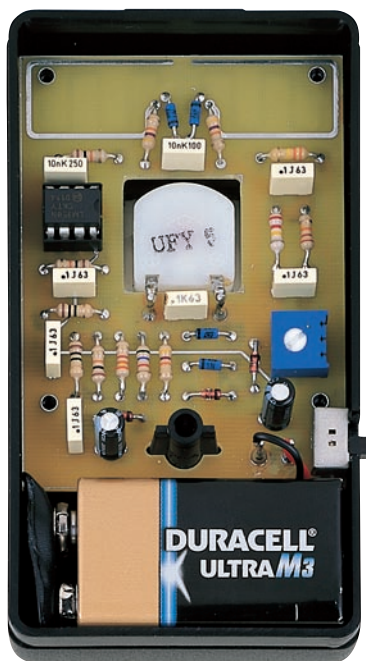
Figure 8 : Photo d'un des prototypes du détecteur de fuites SHF installé dans son boîtier plastique. On remarque les cosses du galvanomètre \mu A soudées sur les picots disposés de part et d'autre de C10.
