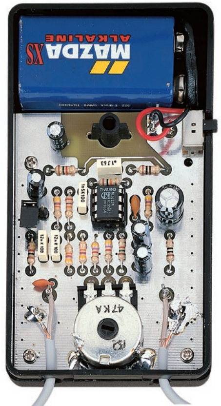
Figure 1: Photo de la platine du préamplificateur installée dans son boîtier plastique. En haut, le logement pour la pile 6F22 de 9 V.
