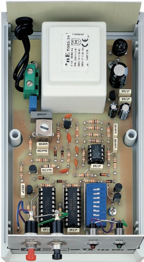
Figure 1: Sur cette photo, vous pouvez voir la platine de l'émetteur déjà fixée à l'intérieur de son boîtier ouvert. Remarquez également la face avant avec ses deux poussoirs ON et OFF et les LED rouge et verte de contrôle (voir également la photo de début d'article).
