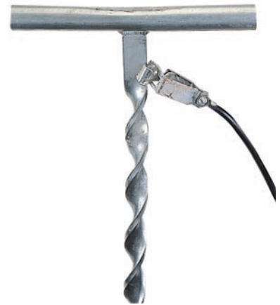
Figure 15: Pour relier électriquement les douilles A et B aux piquets enfoncés dans le sol, vous pouvez appliquer sur leurs extrémités de robustes pinces crocodiles (type chargeur de batterie ou câbles de démarrage).
