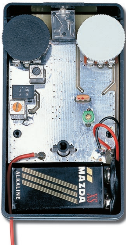
Figure 11 : Montage dans le boîtier du récepteur VHF FM. En ouvrant le couvercle du boîtier plastique, vous trouverez un logement pour la pile 6F22 de 9 V que vous devrez clipser sur sa prise et coucher dans celui-ci avant de refermer le couvercle.
