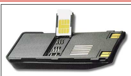
Figure 15 : Pour ôter la carte SIM du téléphone, il suffit d'ouvrir le couvercle sous lequel elle est située, puis la retirer avec précaution.
