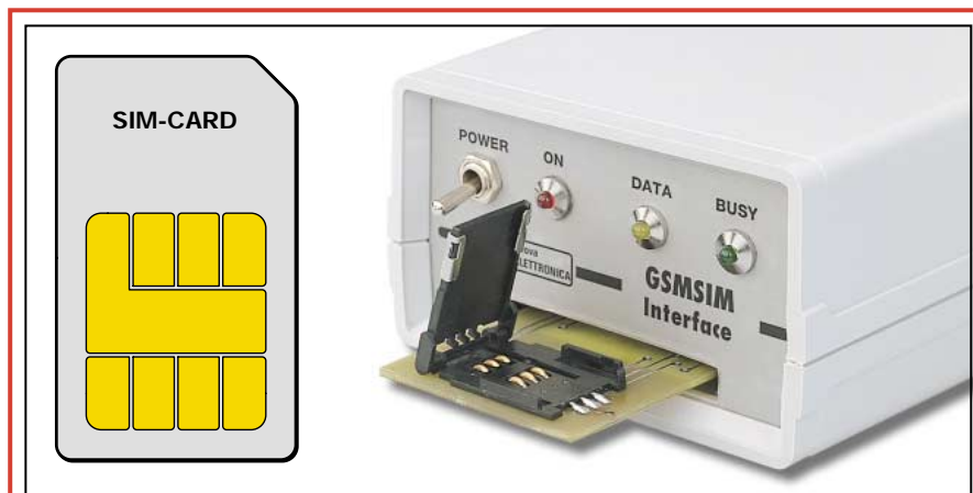
Figure 1 : Tous les numéros de téléphone d'un portable cellulaire sont mémorisés dans la carte SIM. En insérant cette carte dans le lecteur/enregistreur, vous pourrez voir sur l'écran de l'ordinateur, s'afficher tous les numéros mémorisés, en insérer de nouveaux, corriger les erreurs, etc.
