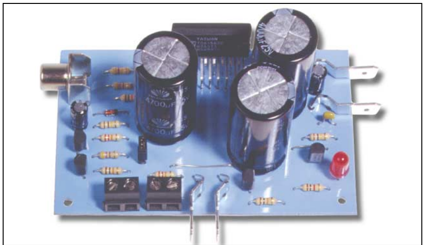
Figure 2 : Schéma d'implantation des composants. Lors du montage, veillez bien au sens des composants polarisés.
