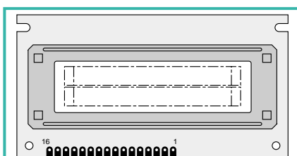
Figure 3 : Brochage de l'afficheur LCD intelligent CLOVER CDL4162. Ce dernier (2 lignes, 16 caractères) est relié au PIC16C84 à travers un bus de données de 8 bits et 3 lignes de contrôle : R/W, E, RS.
