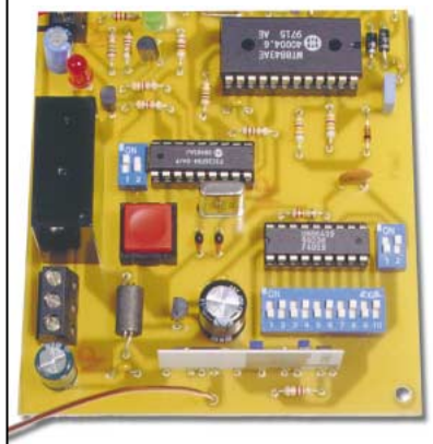
Figure 5 : Vue partielle des étages d'activation. Notre clé avec identification de l'appelant dispose d'une sortie sur les contacts d'un relais et d'un transmetteur codé sur 433 MHz ayant une puissance HF d'environ 200 mW.
