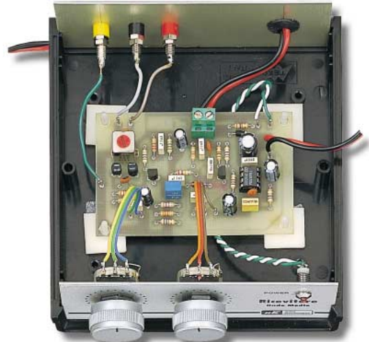
Figure 362 : Pour fixer le circuit imprimé du récepteur à l'intérieur du boîtier, vous devez insérer les axes des entretoises autocollantes en plastique dans les quatre trous du circuit imprimé.
