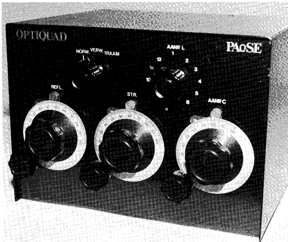
Fig.12. De 14 antennetuners die bij de oorspronkelijke opzet van de DJ4VM-quad nodig zijn om op 7 banden te kunnen werken zijn bij de OPTIQUAD vervangen door dit ene kastje. Hiermee wordt de OPTIQUAD op elke gewenste frequentie in de zeven kortegolbanden tussen 10 en 40 ingesteld op maximum signaal of op maximale voor/achter-verhouding. Dat gebeurt voor reflector en straler met de linker en middelste knop op de onderste rij. Met de rechter knop en de schakelaar rechtsboven wordt de belasting van de zender op 50 Ω ingesteld. De knop linksboven staat bij normaal gebruik in de stand "NORM". In de stand "VERW" wisselen reflector en straler van rol een keer de stralingsrichting van de antenne om. In de stand "1 RAAM" werkt alleen de straler, bij proeven wel eens gemakkelijk (foto: PAoSE).
