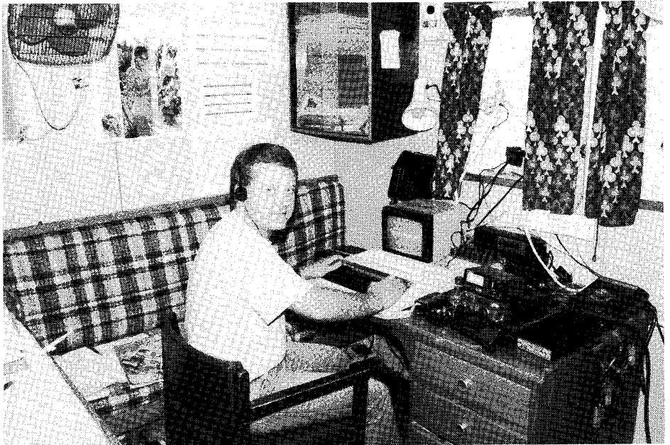
GWOZKG bij zijn station aan boord. De zendontvanger is een TR9130, er achter staat een 100 watt versterker. De BBC computer wordt voor 200 wpm telegrafie bij MS gebruikt alsmede een cassetterecorder.
