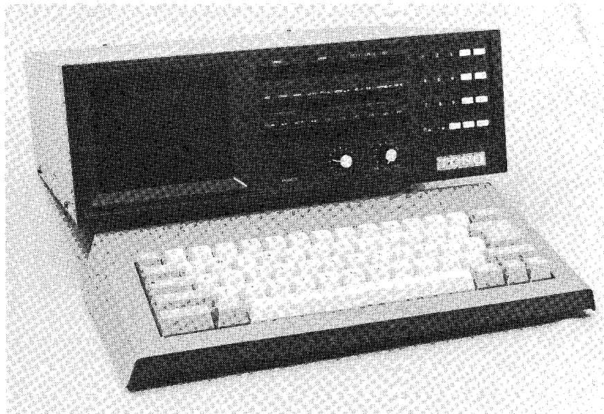
TONO Theta 5000 E, ALL-MODE COMMUNICATIE TERMINAL. CW, BAUDOT, ASCII en nu ook TOR ARQ en FEC.
