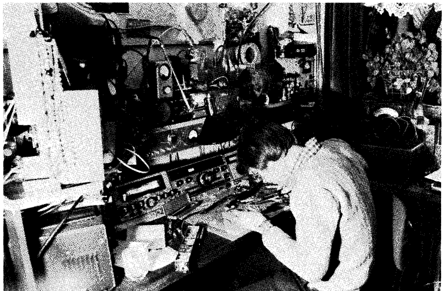
Jan Ottens, PAoSSB, bezig met het in elkaar solderen van de 13 cm voorversterker. Het langwerpige bakje aan de linkerzijde is de 13 cm converter.
