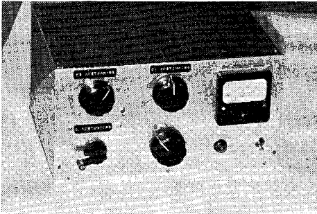
De complete lineaire eindtrap. De afmetingen zijn 17,5 × 33 × 25 cm. (Foto: PAOCRX)
