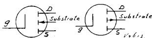
Fig. 10. Links: IGFET met N-kanaal. Kanaal 'verstopt' (verhoogd effect). Vier aansluitingen. Rechts: IGFET met P-kanaal. Kanaal 'verstopt' (verhoogd effect). Vier aansluitingen
