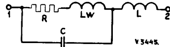
Fig. 4. R = gelijkstroomweerstand; C = gedistribueerde capaciteit; LW = zelfinductie, gevormd door het weerstandsdraad; L = zelfinductie, gevormd door de aansluitdraden
