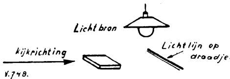
Fig. 12. Spiegeling van een dunne, rechte, lichtlijn in een geslepen kwartsoppervlak
