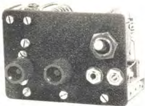
Aspetto esterno del complessino visto dal pannello: si notino, tra l'altro, i due jacks per micro e cuffia, nonché l'elegante manopola di sintonia, ricavata da un tappo per dentifricio!
