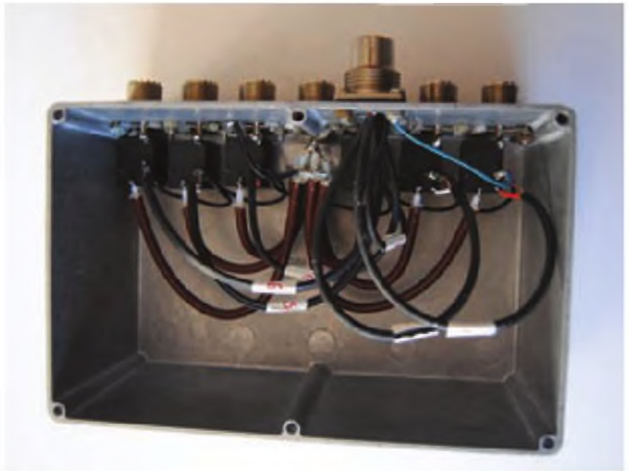
Caja de conmutación remota
