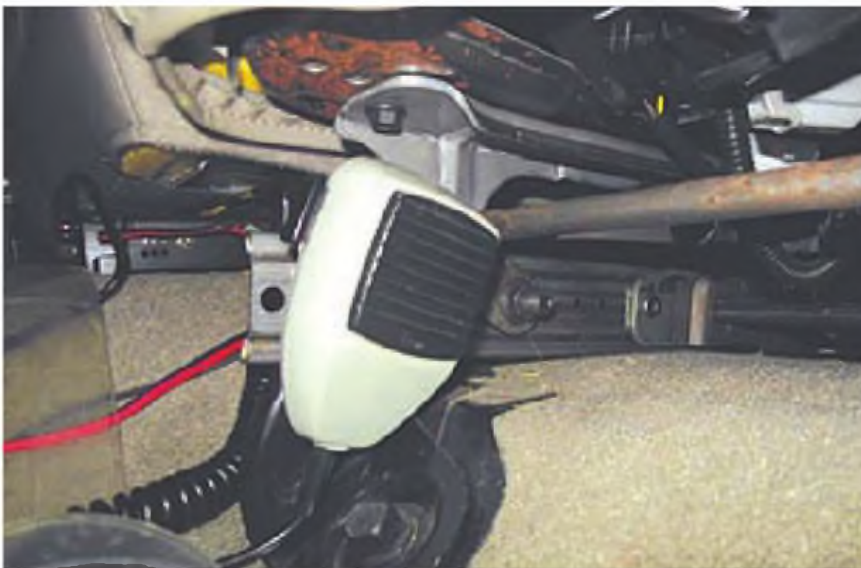
Foto 4: El micrófono queda colocado bajo el asiento. Los cables de alimentación se ven detrás del micro conectados al cuerpo principal del equipo.
