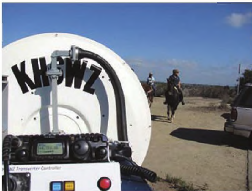
Foto B: Un transverter para 10 GHz puede ser bastante compacto y, aún así, proporcionar muy buenas prestaciones. Esta fue mi instalación en mi primera operación, en Huntington Beach, CA, en el locator DM03xq.
