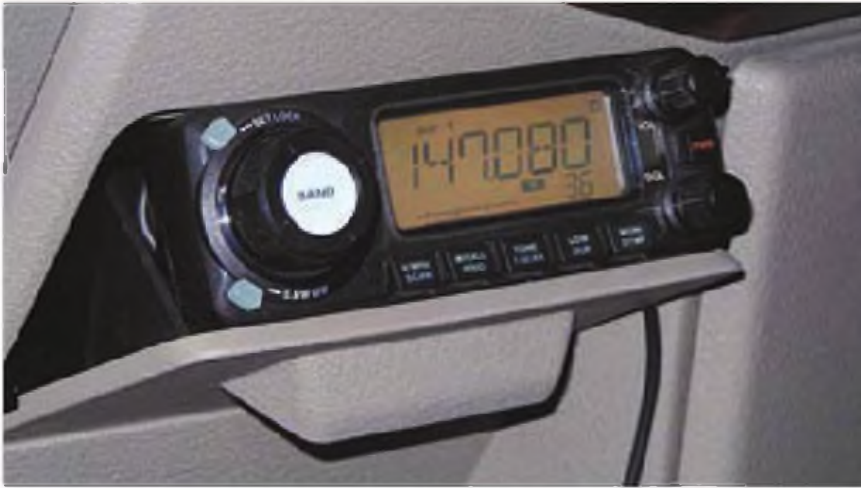
Foto 3: El cabezal de control del Icom colocado en la puerta abatida de la guantera abierta
