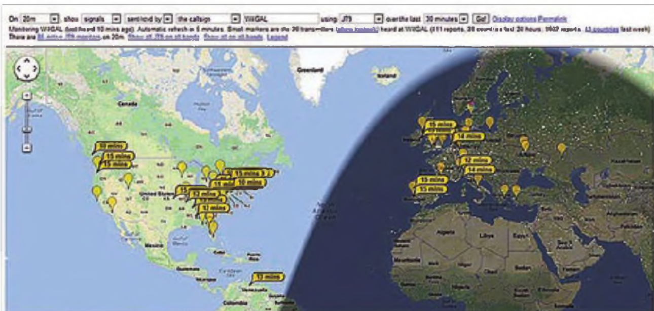
Figura 1: Pantalla de las estaciones que han oído la señal de JT9 del autor con 5 vatios, tal como aparece en la web del PSKREPORTER
