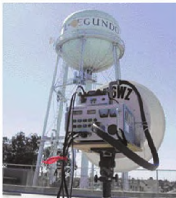
Foto B: Un transverter para 10 GHz puede ser bastante compacto y, aún así, proporcionar muy buenas prestaciones. Esta fue mi instalación en mi primera operación, en Huntington Beach, CA, en el locator DM03xq.
