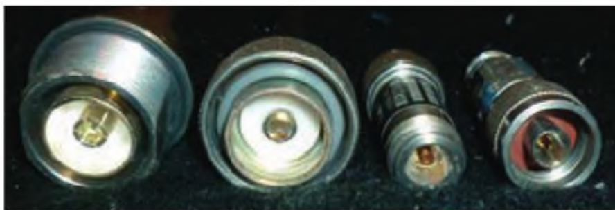
Foto B: Conectores coaxiales DIN 7-16 (izquierda) y conectores N (derecha). Vea la discusión en el texto. En total, se puede acabar la instalación teniendo
