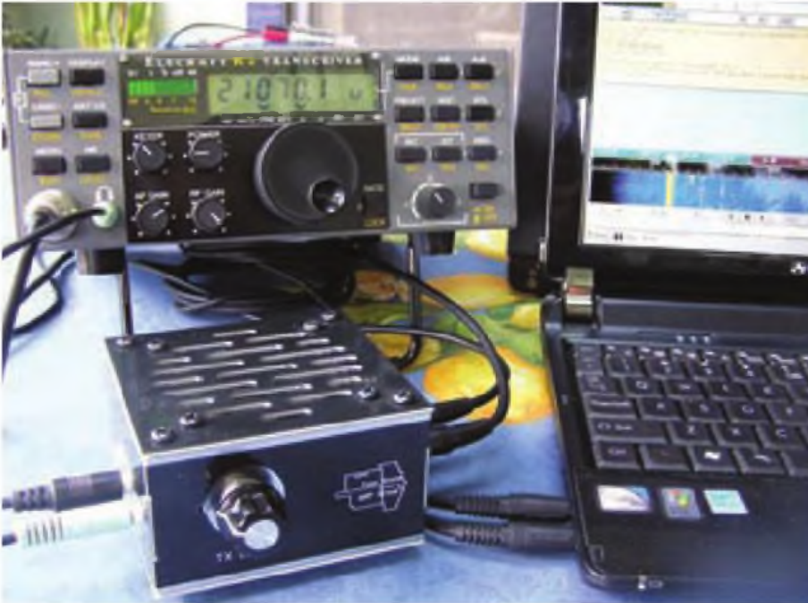
Foto E: La interface de audio 4S-link del Four State Group conectada para una sesión de PSK31.
