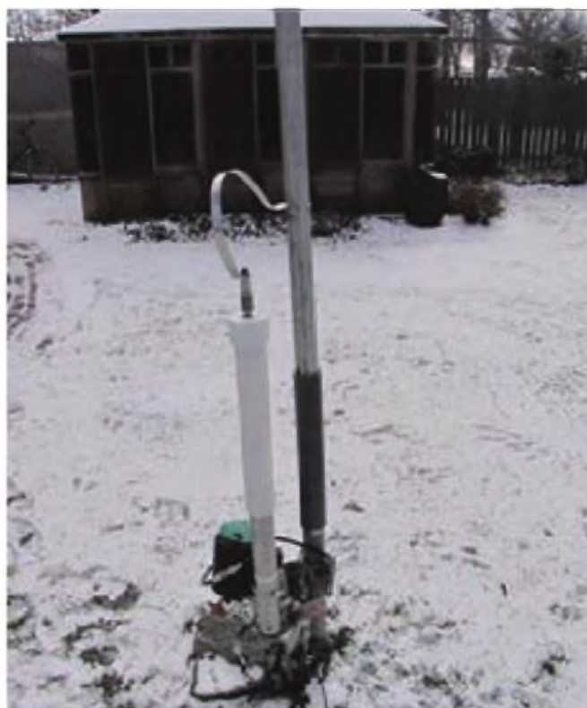
Fotos C y D: A la izquierda el primer diseño de la antena vertical del invierno de 2003. Ahora (foto D a la derecha) dispongo de un montaje mejor aislado para el elemento vertical y va acoplado a la bobina TABA, utilizando un trozo de cinta de acero inoxidable.
