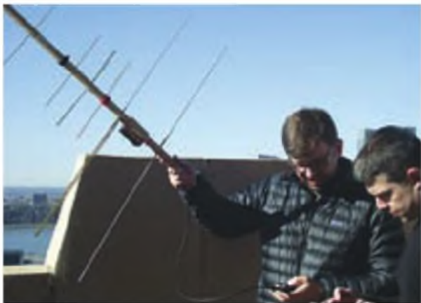
Un portátil y una antena direccional portátil es todo lo que necesitas para operar en algunos satélites en FM. Esta antena es una "Cheap Yagi" de construcción casera, diseñada por el Editor de Antenas de CQ, Kent Britain, WASVJB. Aquí están Dave Clausen, W2VV, y Bill Ward, KD4ISE, intentando trabajar el SO-50 desde la terraza de un hotel en Nueva York. Observa el ángulo de la antena como se describe en el texto (Foto cedida por W2VU).
