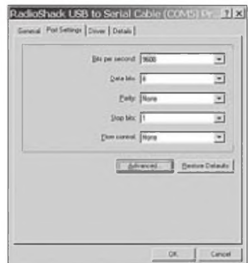
Figura 6. Los parámetros del puerto serie RS-232 que han sido abiertos con la opción "Propiedades" del "Administrador de dispositivos". Aquí podemos fijar la velocidad en baudios y los bits de paridad y stop. Estos se pueden modificar mediante un clic en el botón "Advanced".
