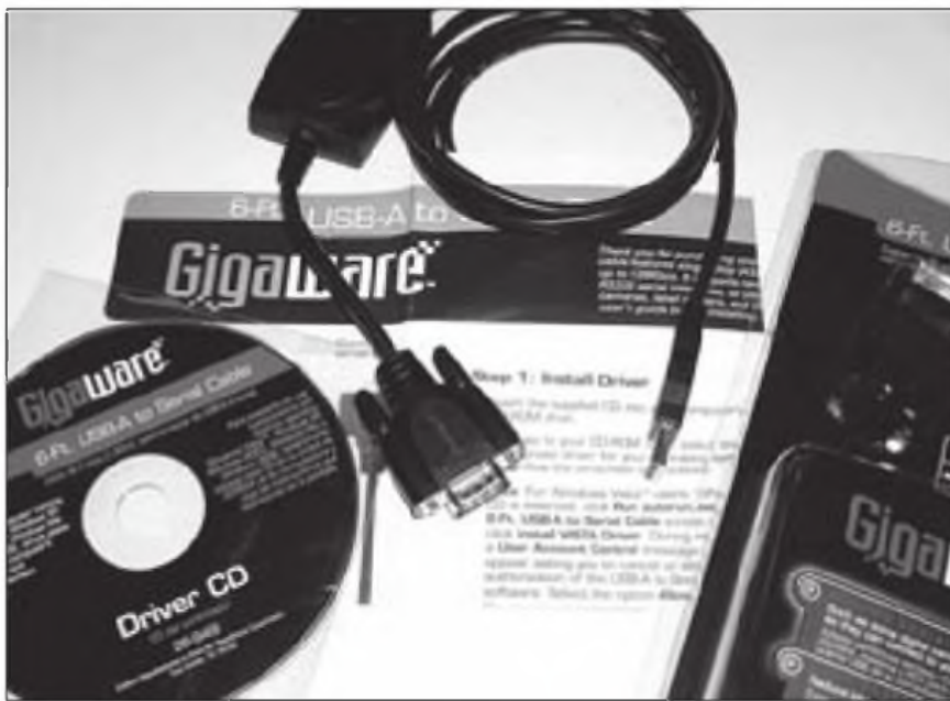
Figura 4. Adaptador de USB a RS-232 de Gigaware. Hay adaptadores de todas marcas y estilos, pero todos son similares a este. Sigue las instrucciones para instalar el driver del dispositivo o no funcionará debidamente. No te olvides de leer el manual para descubrir cómo configurar los parámetros correctos del RS-232.
