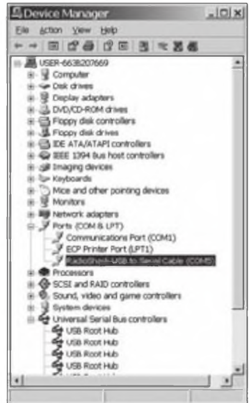
Figura 5. La ventana o menú del "Administrador de dispositivos" se obtiene haciendo doble clic en el icono "Sistema" del "Panel de Control". Luego se debe abrir la + del Puertos (COM & LPT). Clicando con el botón derecho sobre la línea "RadioShack USB-to-serial-adapter" y seleccionando "Propiedades", podremos desplegar los parámetros del puerto RS-232 y colocar los necesarios. Observa que mi ordenador dispone de varios concentradores raíz .
