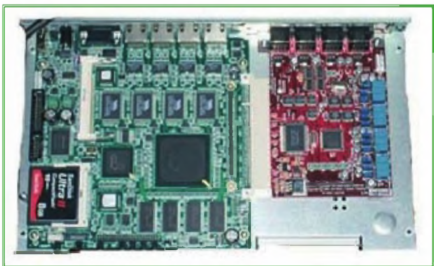
Foto B. Placa Soekris net55001 SBC más tarjeta Quad PCI, todo ello controlado por GNU/Linux Xipar con los módulos app_rpt , chan_echolink y chan_irlp .
