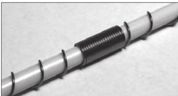
Foto E.- Inductancia separadora de banda.
