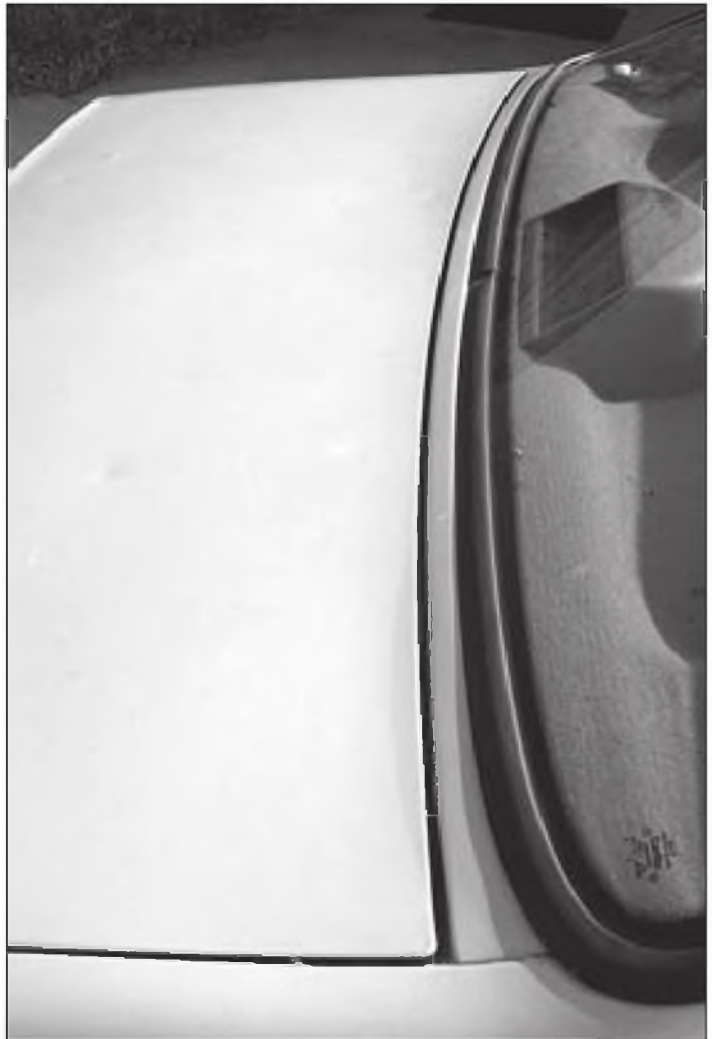
Fotos C.- Utilización de partes de un vehículo como antenas de ranura.
