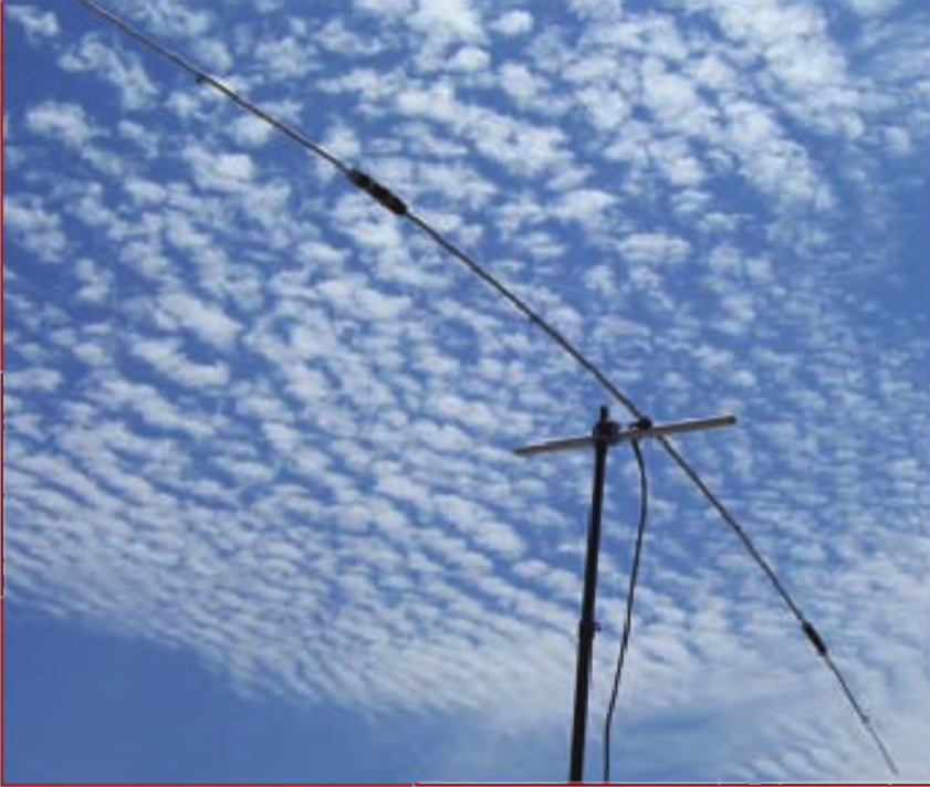
Foto D. El dipolo rotativo para 30 metros montado con las bobinas de carga de la YP-3.
