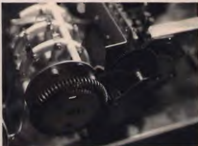
⑨ "Il lavoro più creativo consiste nell'assemblare il motore a 12 V con una opportuna demoltiplica".
