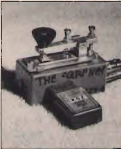
② Il tasto Morse è installato direttamente sopra il contenitore metallico che ospita il TX.
