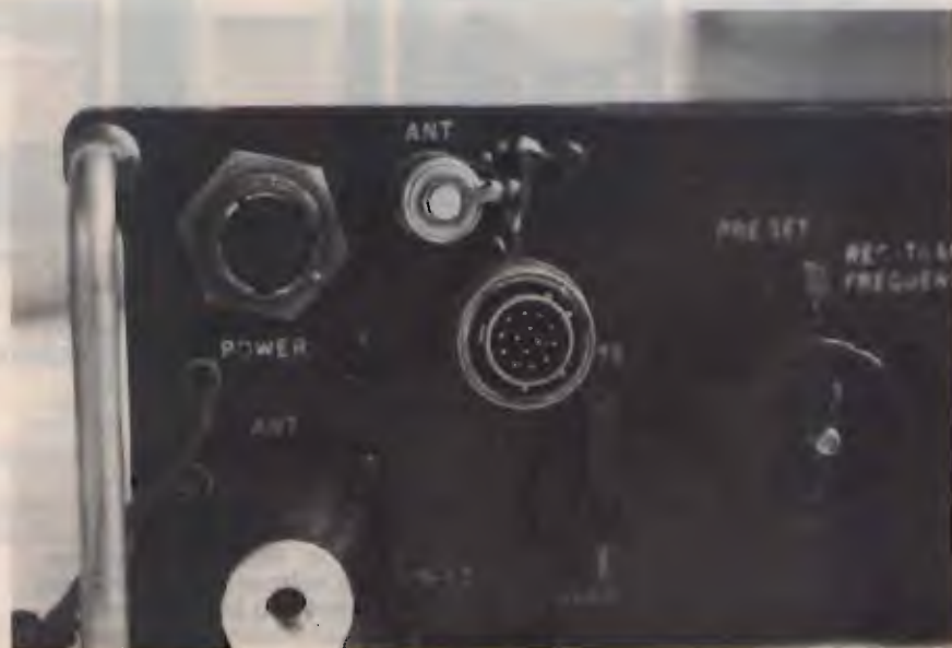
⑥ Particolare del tappo sul connettore J3.
