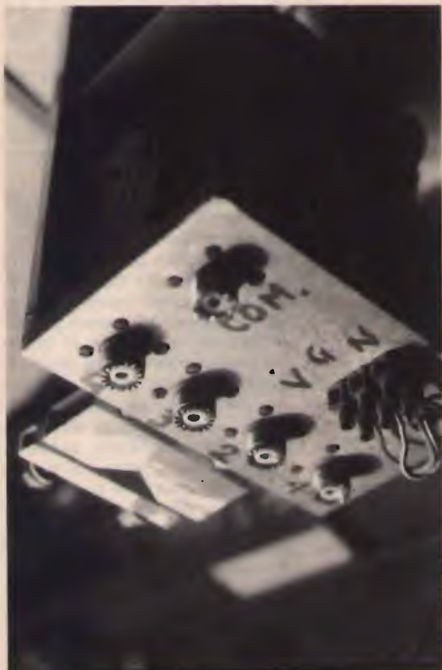
15 Trattandosi di antenne per H.F., nel prototipo sono stati montati quattro comuni attacchi (+ 1 della linea di discesa comune) Amphenol SO239".
