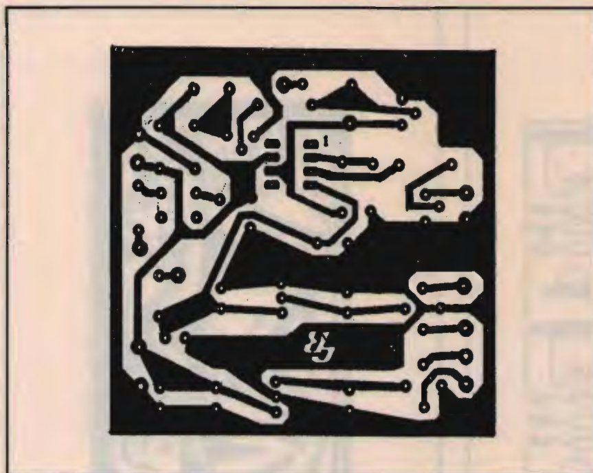
⑤ Circuito stampato dell'alimentatore duale e dell'amplificatore di segnale del sensore.
