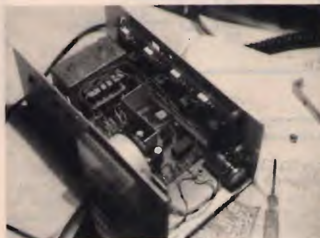
⑪ "Assemblaggio del Box-Controllo".
