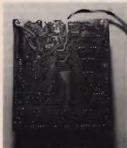
③ La scheda COUNTER UNIT vista da sotto. In alto a sinistra si possono notare i diodi aggiunti.
