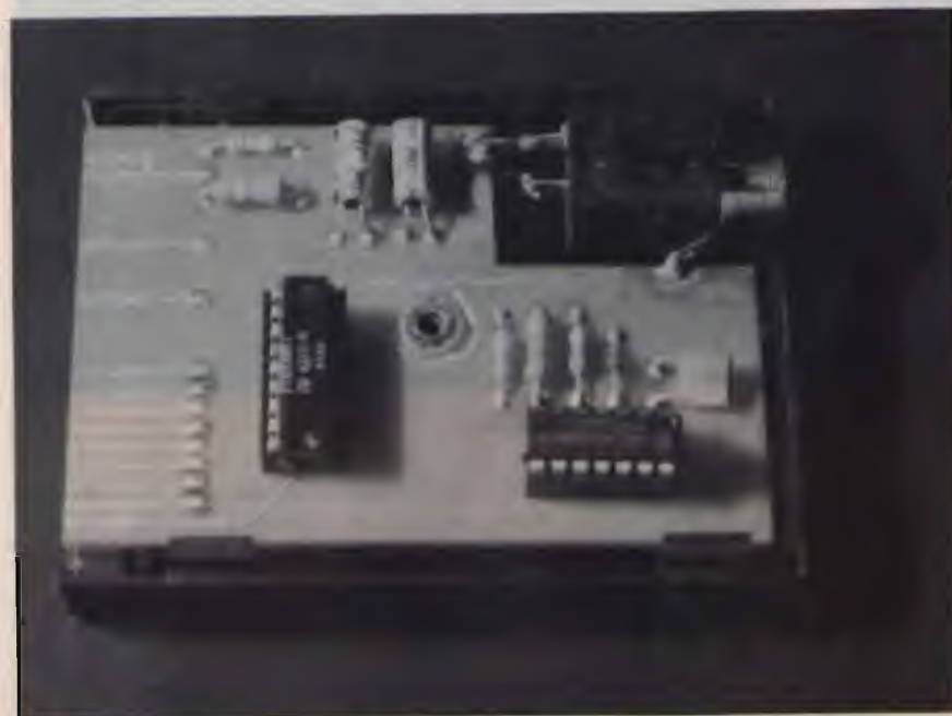
② Alloggiamento del circuito nel contenitore.
