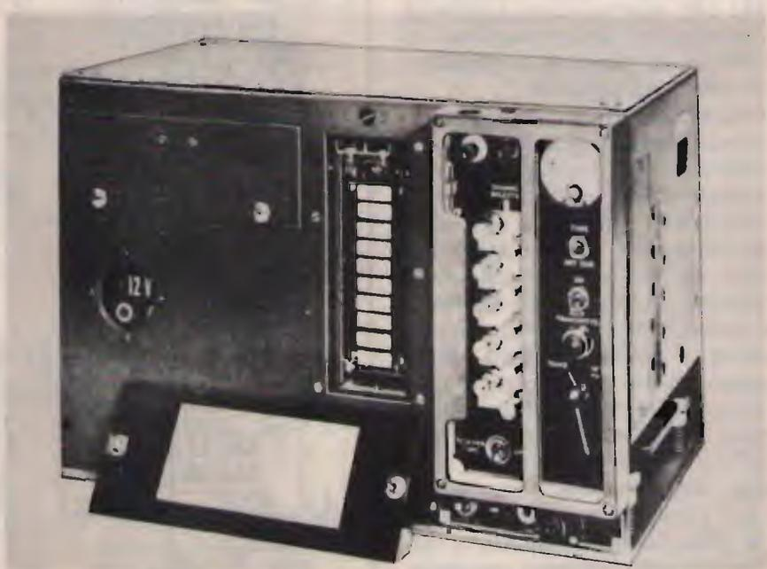
(A) BC 604 Transmitter 27 MC AM-FM. Frequenza coperta da 20 a 28 MC suddivisa in 80 canali corredato di: n. 8 valvole termoioniche. Relè di antenna: doppio contatto in ceramica. Strumento di misura corredato di termocoppia R.F. Dimensione del BC: cm 40 x 30 x 15. Peso circa kg 22.
