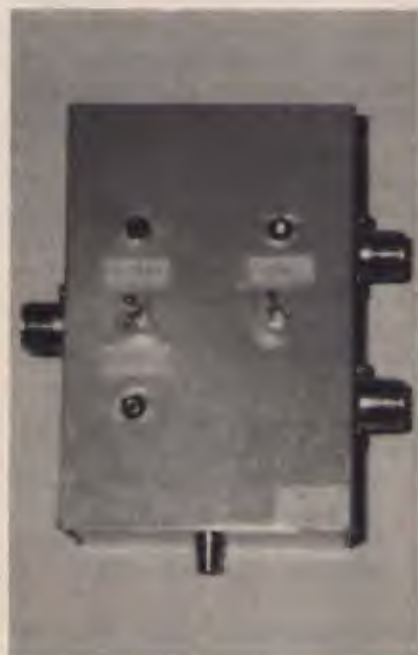
① Vista dall'esterno dell'unità di commutazione.
