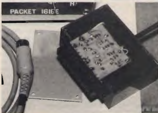
③ Interfaccia optoisolante per MBA-TOR RTTY/CW/ASCII/Amtor, lato componenti e lato saldature.
