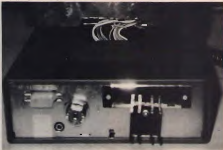
④ Retro dello Zodiac M5040 e cavi che entrano nella unità duplex.
