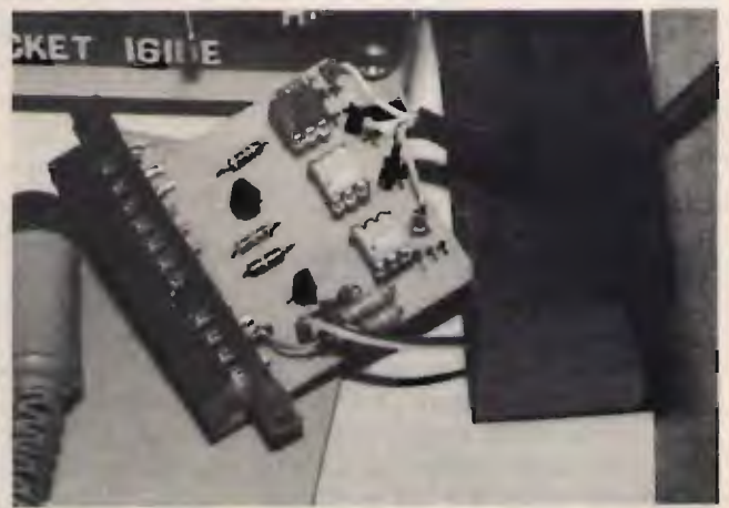
③ Interfaccia optoisolante per MBA-TOR RTTY/CW/ASCII/Amtor, lato componenti e lato saldature.
