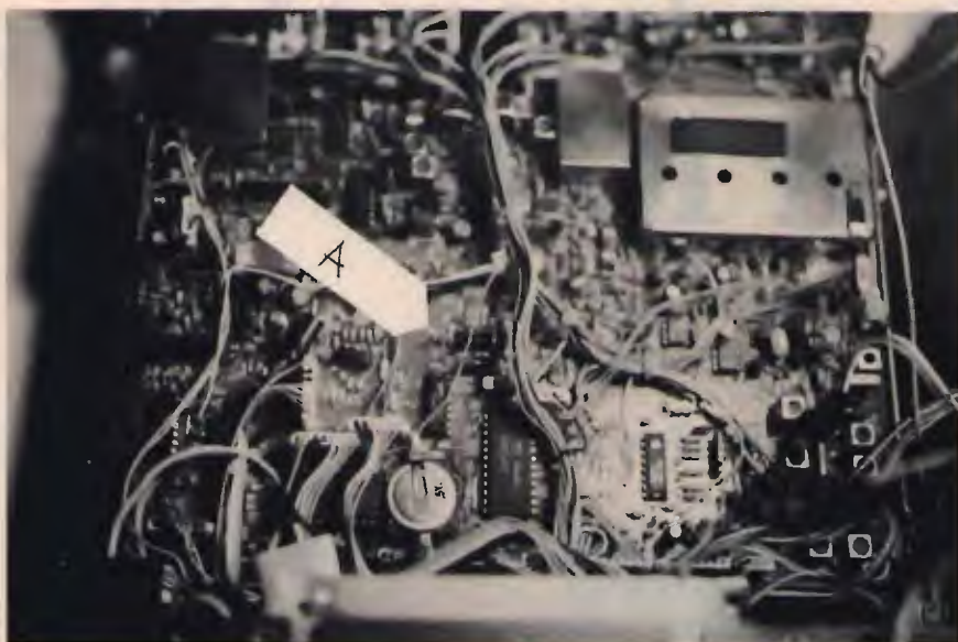
③ La freccia "A" indica la zona dove sono posizionati i diodi D-33 e D-34.
