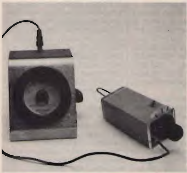
foto A L'ondamento collegato allo strumento indicatore esterno.
