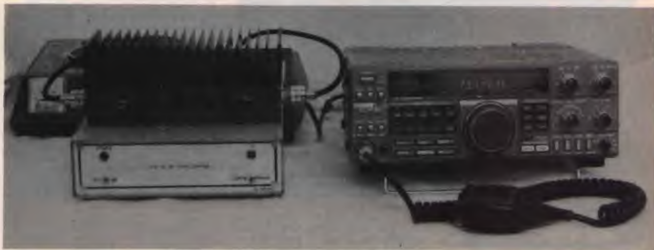
foto 1 Amplificatore lineare a realizzazione ultimata in opera con transverter e TS 440.
