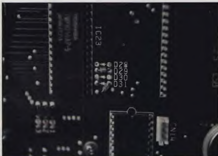
foto 5 Il diodo "D 31" dopo la modifica.
