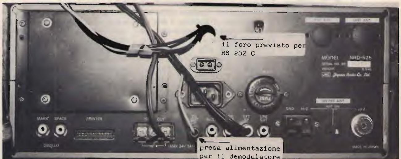
Vista del pannello posteriore del ricevitore JRC NRD 525. Si nota il foro preesistente e previsto per l'innesto del connettore RS 232 C, dal quale è stato tolto il tappo in plastica simile ai due per VHF e UHF ANT. Nel caso detto foro sia utilizzato per il connettore RS 232 C, i due cavetti (coassiale per I.F. e schermato stereo per B.F.) possono fuoriuscire da una delle feritoie di ventilazione del coperchio del ricevitore. L'alimentazione per il demodulatore SPD1 viene prelevata dalla presa plug DC OUT.
