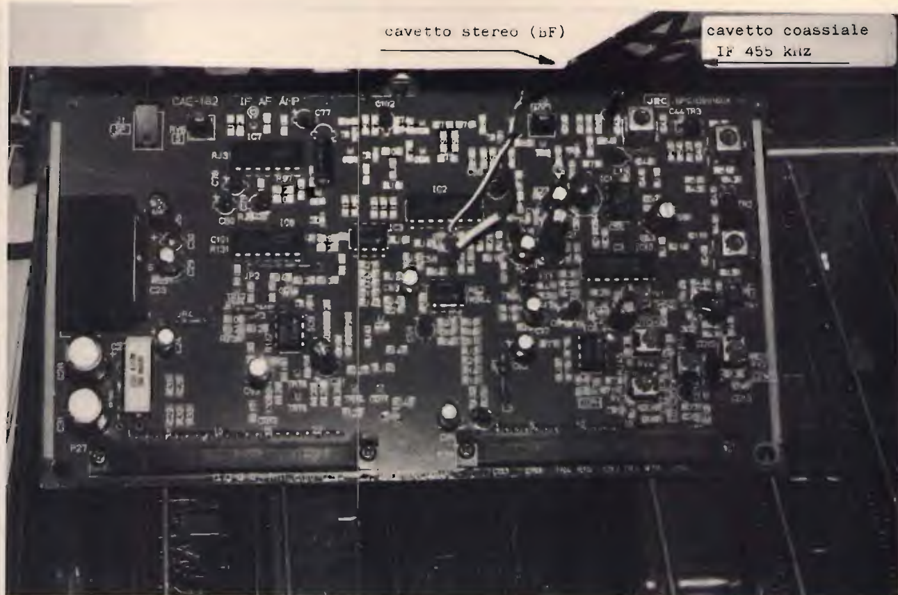
La scheda CAE 182 IF AF AMP. del ricevitore JRC NRD 525. Sono chiaramente visibili i punti di collegamento del cavetto stereo per la B.F. e del cavetto RG 174 per il prelievo del segnale F.I. 455 kHz.
