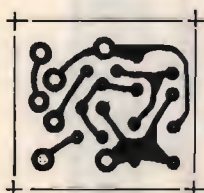
Circuito stampato del modulo preamplificatore micro. Scala 1:1. N.B.: i componenti vanno montati verticalmente.
