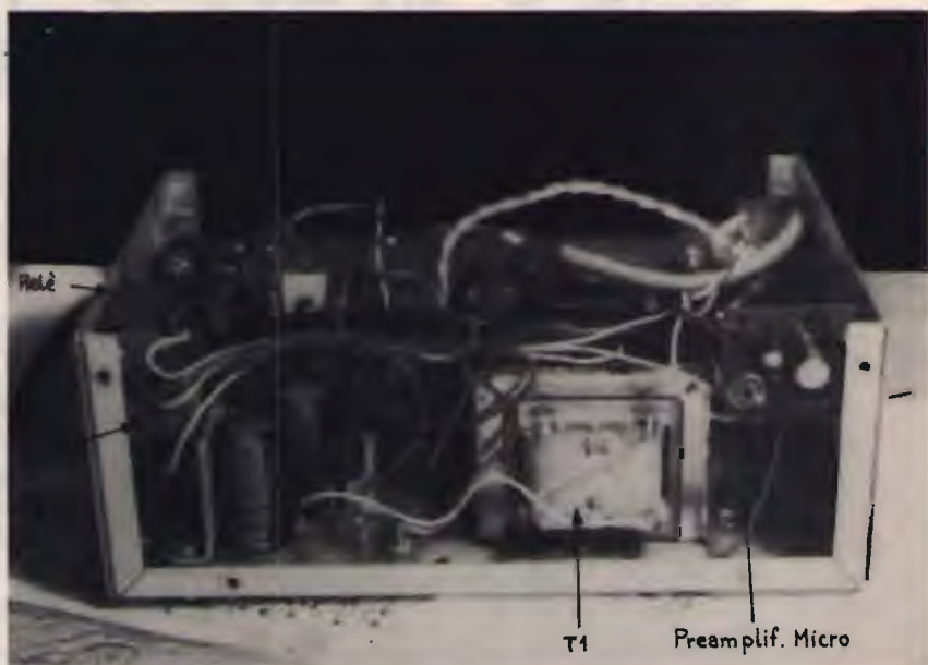
Cablaggio del prototipo: è visibile, sulla destra, il modulo preampli microfonico. A sinistra il relé e, in primo piano, la sezione alimentatrice.
