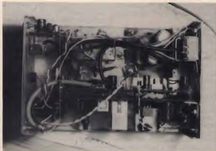
Vista dall'alto del cablaggio. Il telaio a R.F. e quello dell'ampli BF/oscillatore BF sono tenuti distanziati tra loro da opportune rondelle isolanti.
