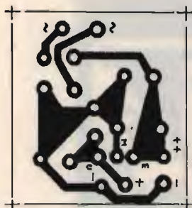
Circuito stampato del modulo alimentatore. Scala 1:1.
