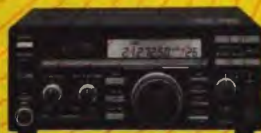
ICOM IC 725 - Ricetrasmittitore HF, compatibile a tutti i modi operativi, 26 memorie, compatto, modi AM, FM, SSB, 200 W/PeP, alim. 13,8 V Dc.
