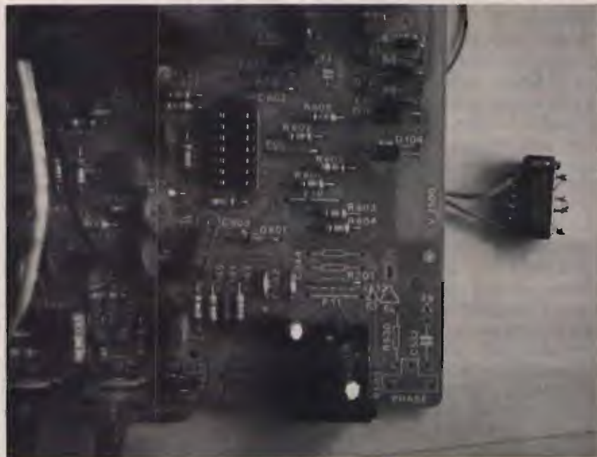
foto A Particolare del circuito stampato del monitor Philips BM7613. È visibile il ponticello F10. Lo zoccolo per il circuito integrato è stato montato per le prove. A lato è visibile il sandwich 74LS86 e 74LS02 che va montato sullo zoccolo.
