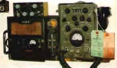
COLLINS 618T - Ricetrasmittitore SSB - 400-700 W. out 2÷30 MHz in varie versioni.
