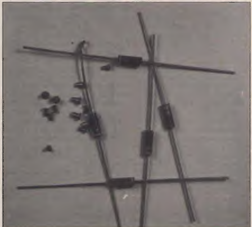
foto 1 Il carico fittizio vero e proprio è rappresentato da una serie di resistori a impasto da 15 ohm.
