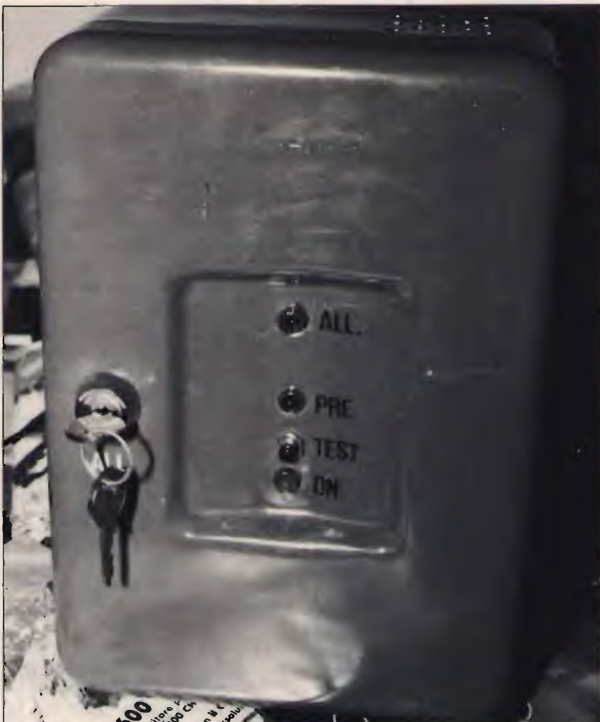
foto 3 Allarme finito. Notare il contenitore costituito da un box portavalori, in metallo, con maniglia asportata.
