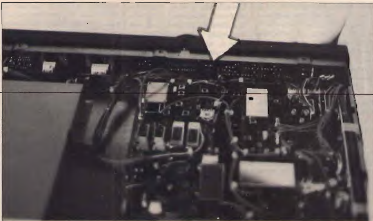
foto 6 La freccia indica dove si trova il diodo D-53 da tagliare.
