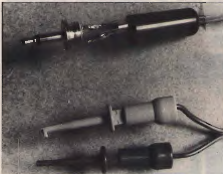
figura 6 I cavetti per i terminali di prova.
