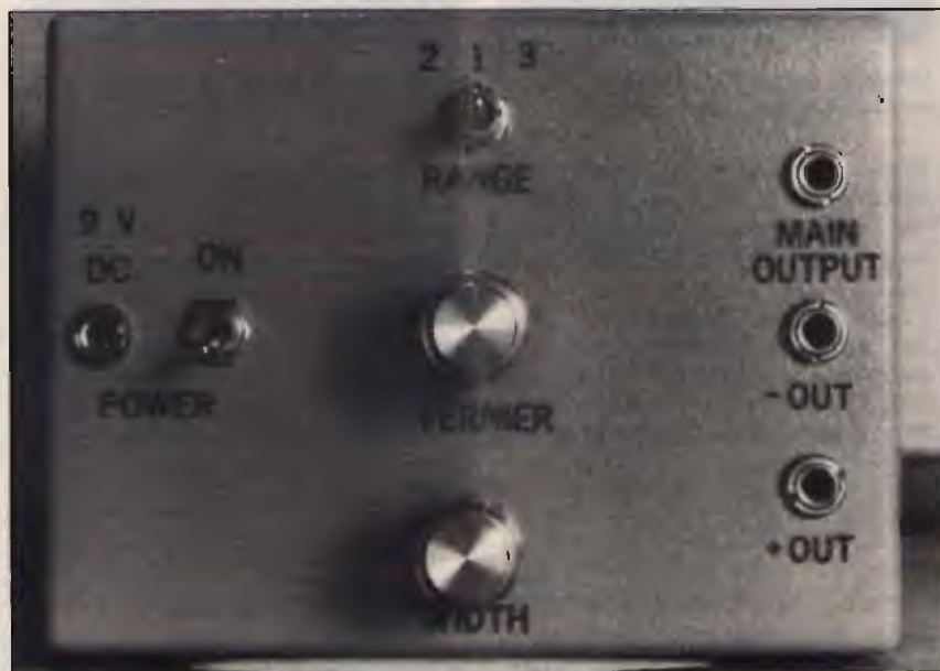
figura 4 Pannello frontale del generatore di impulsi.
