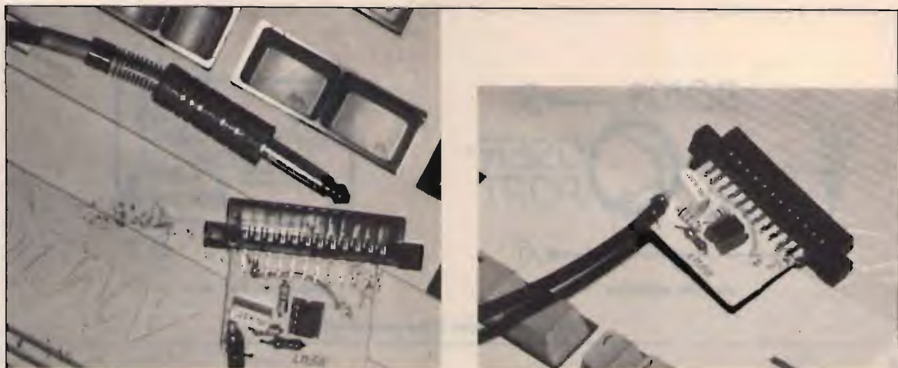
Interfaccia FAX-SSTV, vista da due diverse angolazioni.
