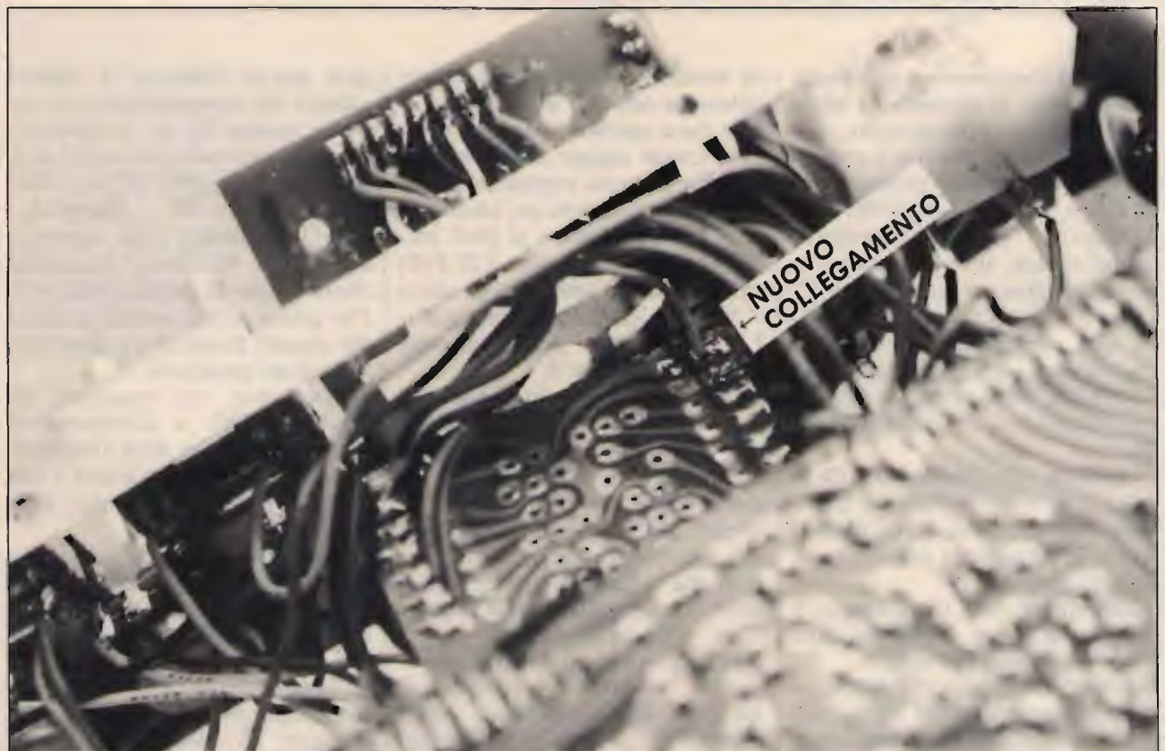
figura 3 Dissaldato il vecchio commutatore, è tempo d'inserire il nuovo.
