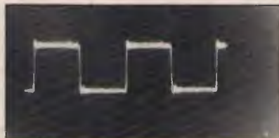
Onda da 1,5 MHz su carico di 100 ohm.
