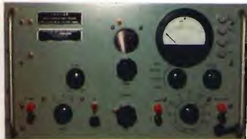
Spectrum analyzer TS 723 D/U strumento per misurare la banda passante su segnali radio in B.F.
