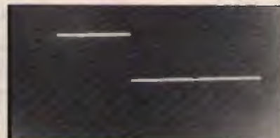
Impulso da 75 microsecondi (massima ampiezza).
