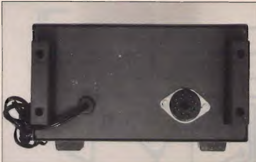
foto 2 Il collegamento tra control box e rotore è ottenuto mediante uno zoccolo octal.
