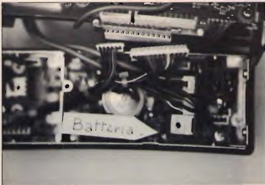
figura 5 Individuazione della batteria al litio che alimenta la CPU.
