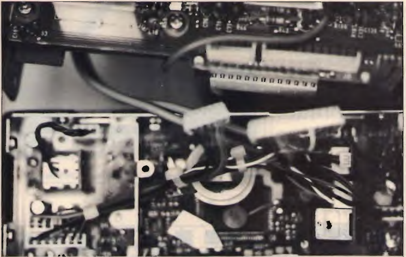
figura 6 Il diodo D19 deve essere eliminato.
