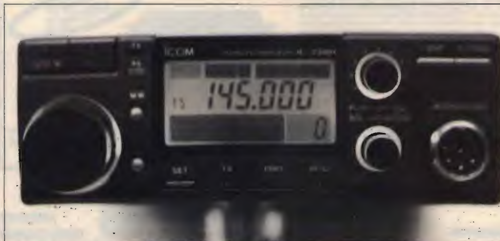
figura 1 Il design essenziale e moderno, e la nitidezza del display LCD, caratterizzano il ricetrans VHF-FM IC228 H.
