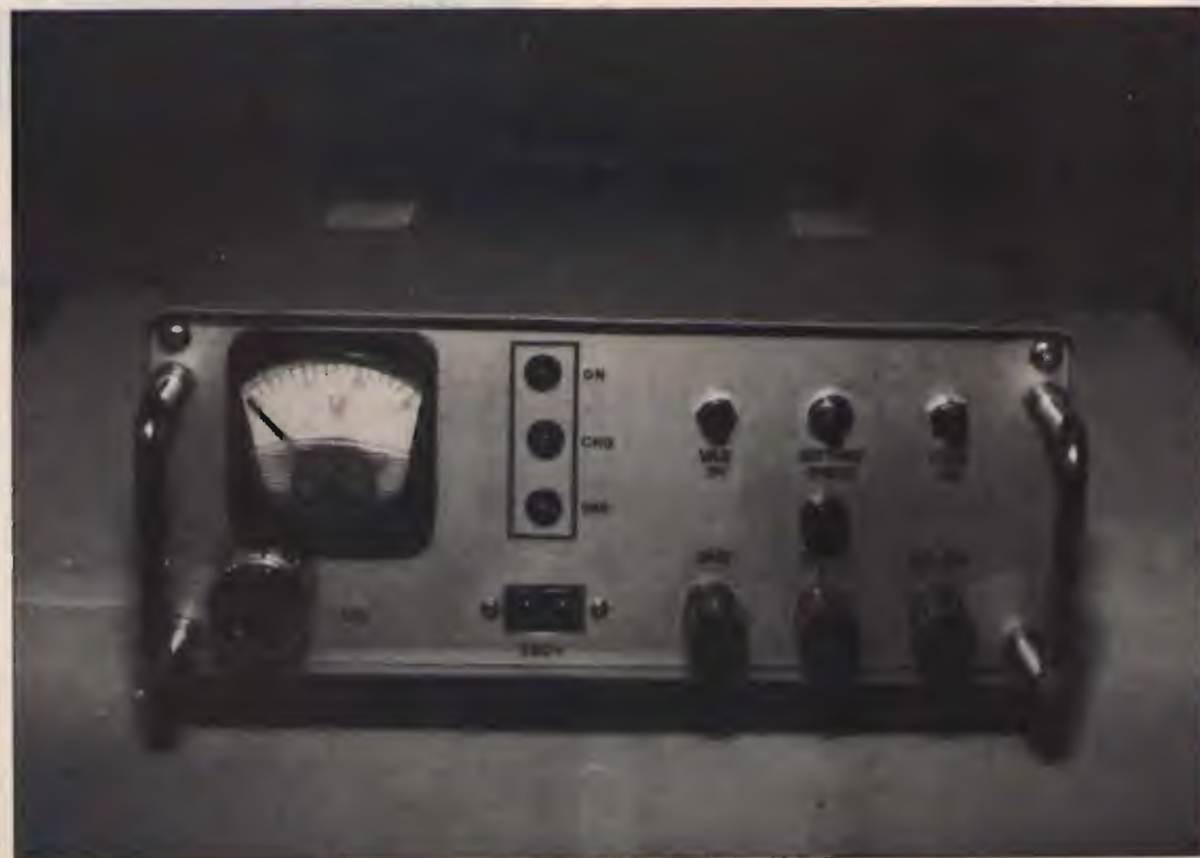
foto 1 Vista frontale dell'alimentatore a batteria con i comandi e le prese del pannello anteriore.
