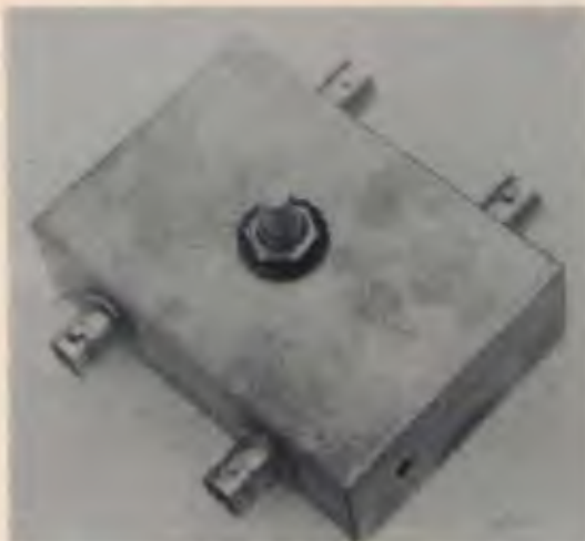
Invertitore d'antenna in fase di montaggio. Il contenitore è in robusta lamiera zincata.
