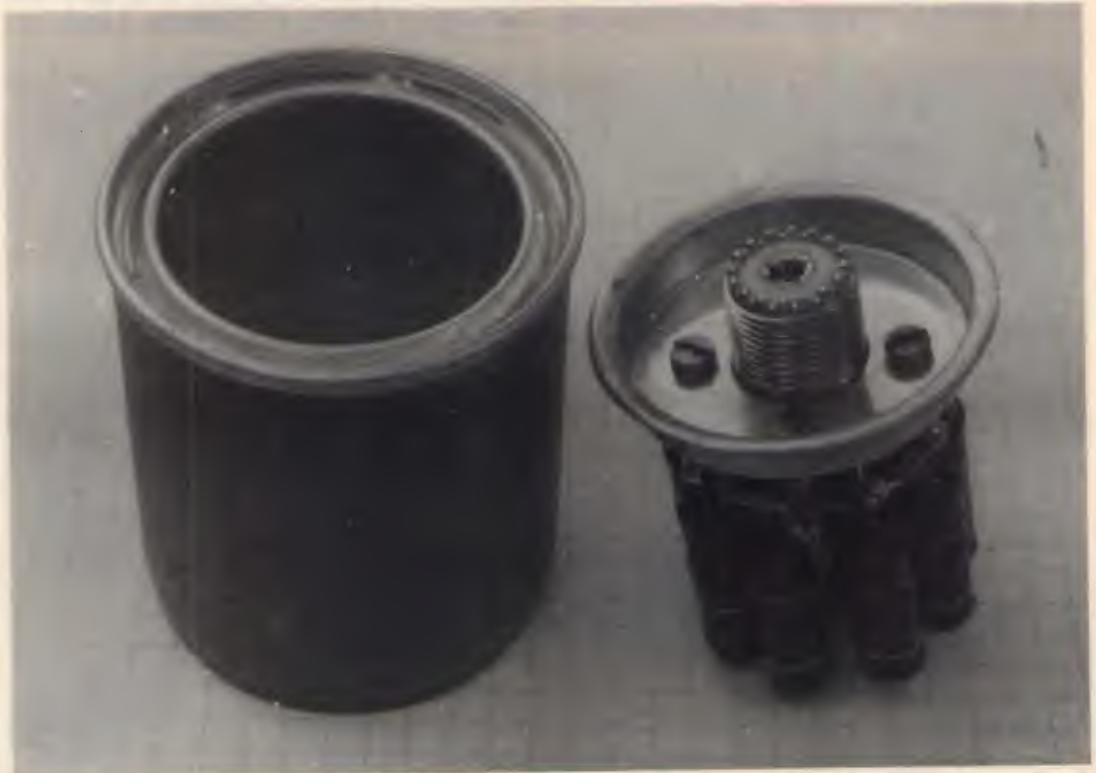
Il carico fittizio a montaggio ultimato. Non resta che versare l'olio minerale e chiudere il contenitore.
