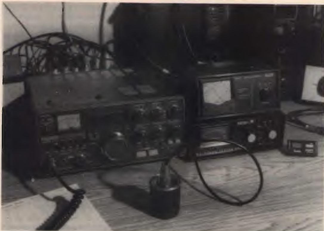
Il carico fittizio sul piano di lavoro durante una prova per controllarne la potenza dissipabile. Il Dummy Load si comporta egregiamente anche alle altissime frequenze (UHF). In questa foto si effettua una prova di dissipazione sui 435 MHz.
