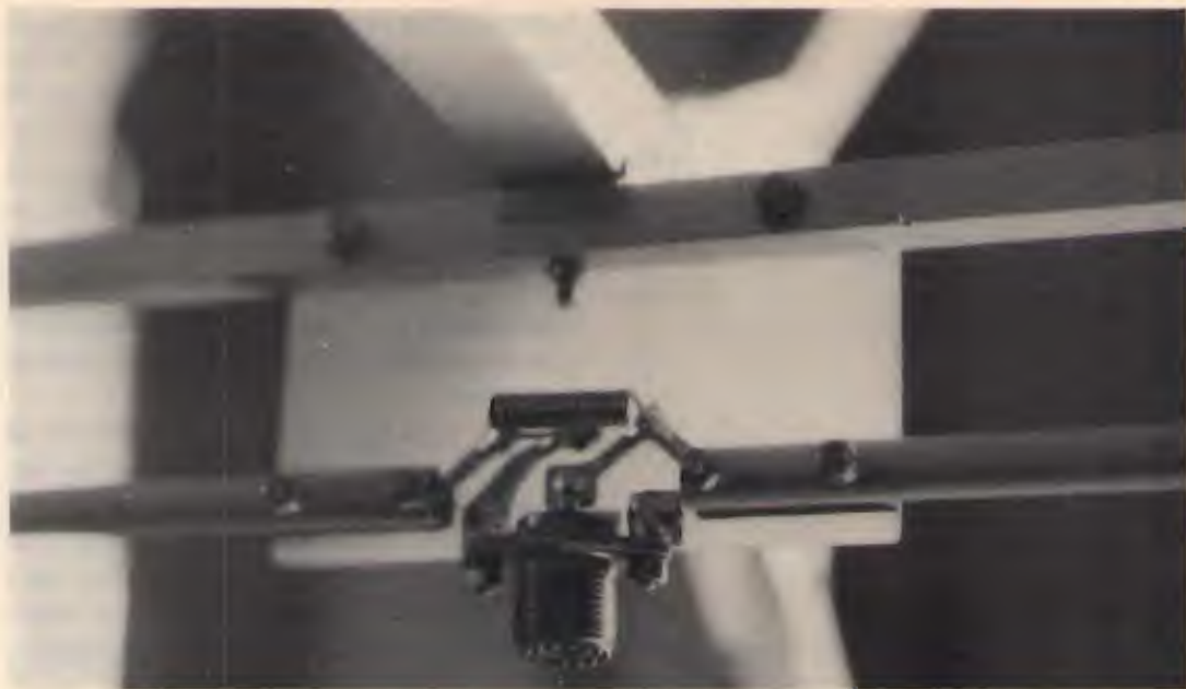
Particolari di realizzazione della basetta in vetronite.
