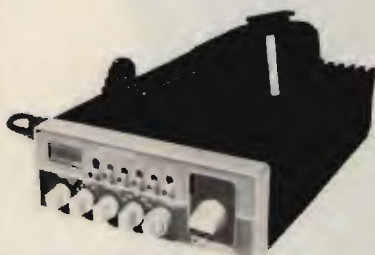
AFS805 MK II 10.000 canali in AM-FM-USB-LSB-CW 100 W in 3 potenze sintonia continua + canali Alfa RF Gain + Beep
