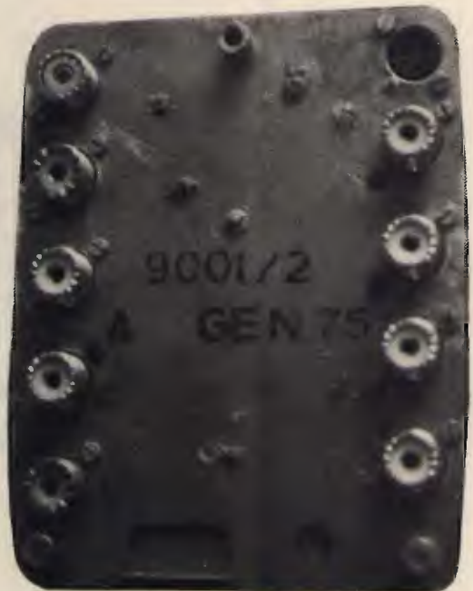
Vista inferiore del commutatore realizzato nella scatola URMET.
