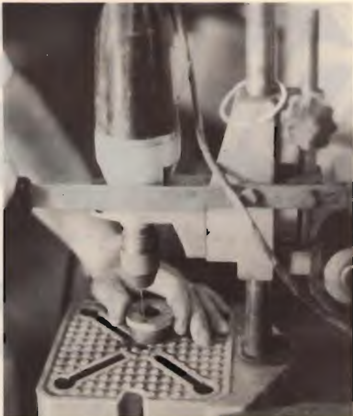
Un piccolo trapano da banco risulterà utilissimo per le operazioni di foratura: preparazione della riduzione tronca 1/4 - 1/2 pollice.
