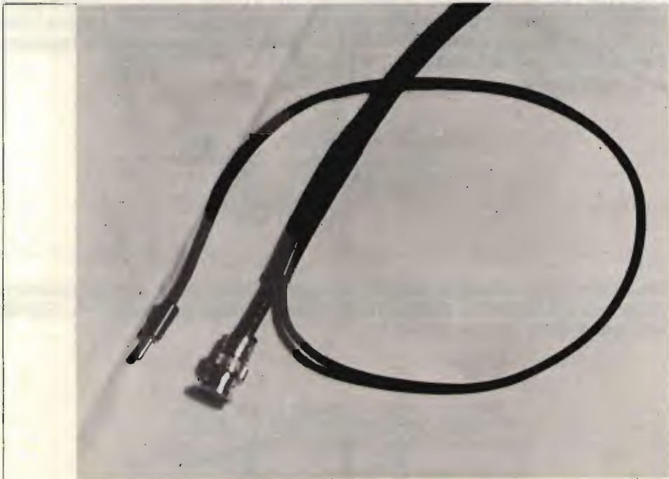
Particolare del punto di divisione RG-58 - filo rosso dell'alimentazione.
