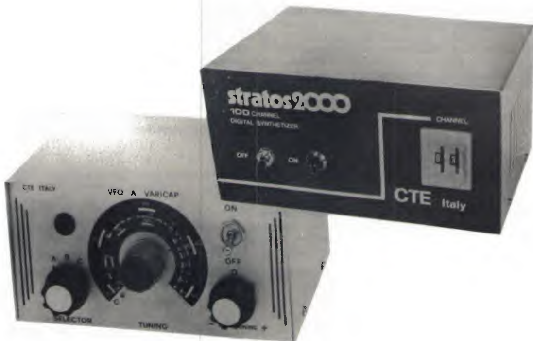
Da sinistra: VFO a varicap e sintetizzatore digitale CB « stratos 2000 ».
