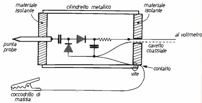
Durante l'uso, il cavetto coassiale è spesso sottoposto a tensioni, fate quindi in modo che il cavetto non « tiri » la basetta su cui sono stati saldati i componenti per evitare di danneggiarli.
