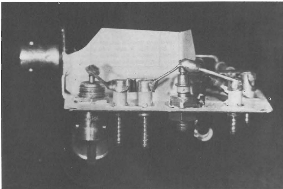
Per la taratura si procede nel seguente modo: si applica un wattmetro passante all'entrata e un carico fittizio resistivo ( $52 \Omega$ ) all'uscita del triplicatore. Successivamente si eccita il triplicatore con una potenza di circa 5 W in 432 MHz, si accorda il circuito d'entrata ( $C_2$ ) per il minimo « ros » letto al passante (vedi Wattmetro, cq 11/1975) e per la massima potenza assorbita.
