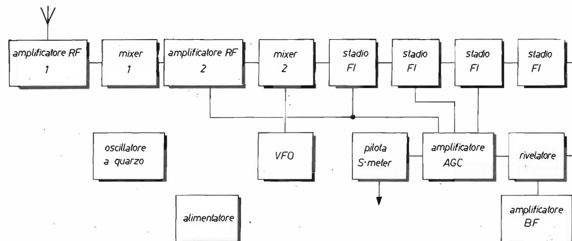
Il primo convertitore è pressochè uguale, come già detto, al CB-cvr, ovvero l'amplificatore RF è costituito da un circuito cascode di fet che amplificano il segnale successivamente trasferito al mosfet Q<sub>3</sub>, mescolatore di prima conversione che riceve anche il segnale generato dall'oscillatore a quarzo Q<sub>4</sub>, necessario appunto per effettuare la prima miscelazione.
