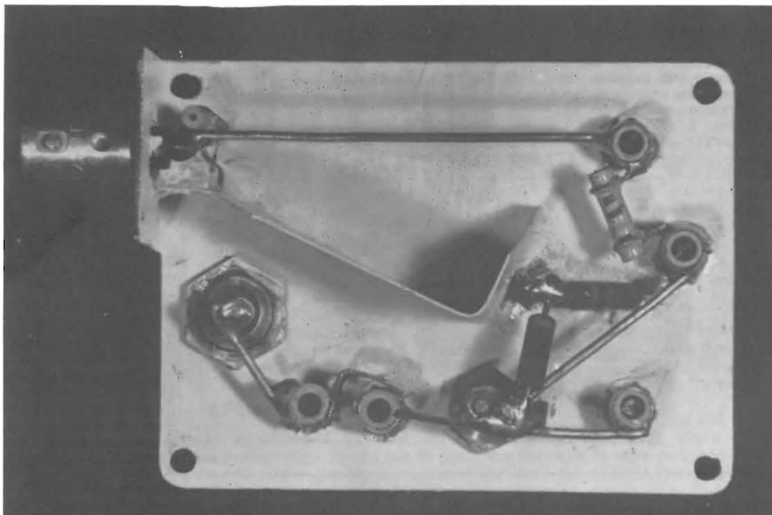
Il contenitore sarà di lamiera di ottone argentata dello spessore di 1 mm e della dimensione esatta (vedi figura 1) a quello già sperimentato.
