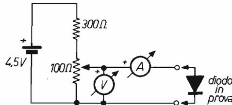
Non è affatto necessario usare proprio una batteria di 4,5 V, va bene qualsiasi batteria, si deve solo cambiare il valore delle resistenze; si deve fare in modo che la tensione ai capi del potenziometro sia di circa 1 V, per poter determinare, con comodità, la tensione di soglia. I due strumenti vanno predisposti all'incirca con il fondo scala indicato in figura 5.
