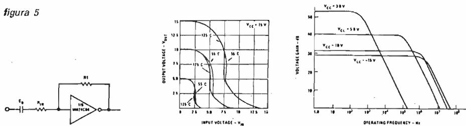
Rispetto ai normali operazionali presentano poi il vantaggio della maggiore dinamica di uscita, che è prossima alla tensione di alimentazione, con le contropartite di un basso guadagno a bassa frequenza, di una estrema dipendenza dei parametri dalla tensione di alimentazione e di un isolamento tra i vari inverters contenuti in un involucre, che spesso è insufficiente.
