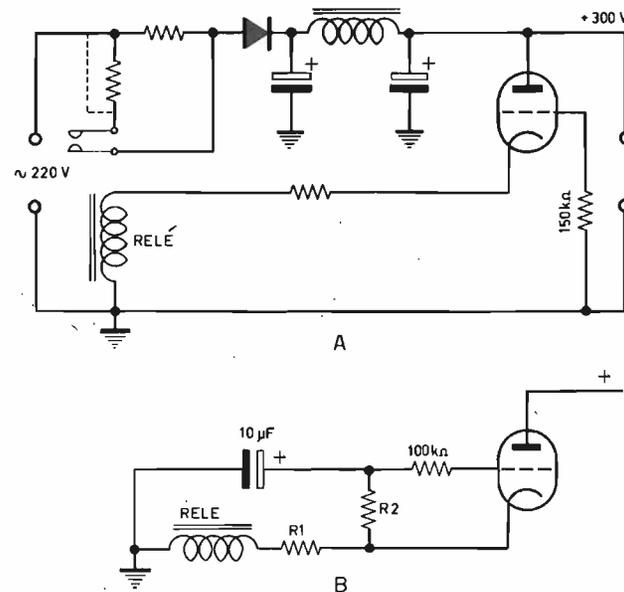
A seconda del carico previsto, si sceglierà una resistenza di valore adeguato (circa 100  $\Omega$ ), che sarà cortocircuitata con o senza interposizione di una resistenza di protezione supplementare di piccolo valore (circa 4,7  $\Omega$ ), al momento in cui la tensione in uscita raggiunge all'incirca il suo valore normale.
