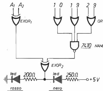
Ogniquilvolta si creerà una delle combinazioni 10, 19, 29, il NAND avrà come uscita 1 che, infilata nell'OR ESCLUSIVO 2, ne invertirà il risultato. Per quanto riguarda il manque e il passe, bisogna munirsi di due MAGNITUDE COMPARATORS (7485) che vanno piazzati sulle due decadi di conteggio (figura 4).
