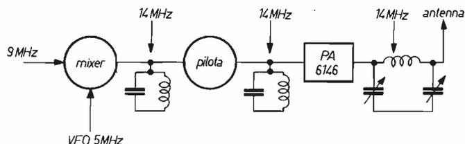
Al mixer arrivano il segnale in SSB (proveniente dall'exciter) e il segnale a 5 MHz del VFO. All'uscita, abbiamo i 14 MHz che poi un « driver » (pilota) provvede ad amplificare per poter pilotare un PA costituito da due 6146.
