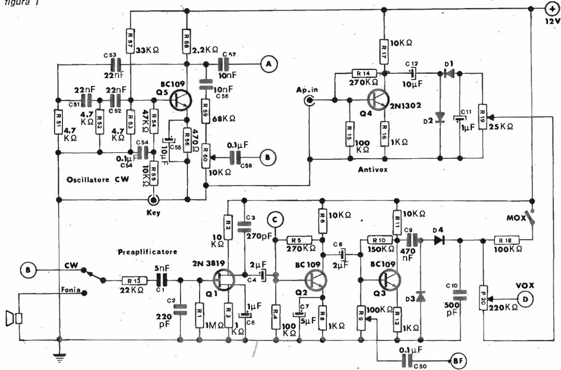
La presa C è prevista per inserirvi un auricolare che potrebbe servire da monitor per il controllo della modulazione.
