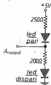
Per quanto riguarda la segnalazione di pari e dispari, si sa fin dalla più tenera infanzia che i numeri binari che finiscono per 1 sono dispari, per cui basta individuare il piedino di A output della decade che conta le unità e operare lo schema a lato (figura 2).
