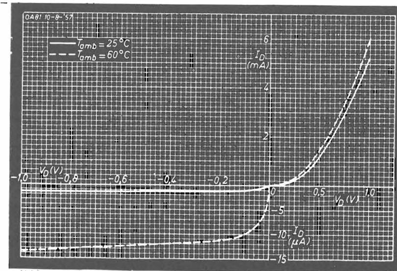
Curve caratteristiche di un diodo OA81 a punta di contatto al germanio.
