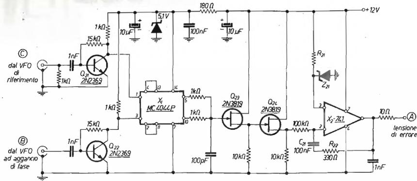
I transistori  $Q_{21}$  e  $Q_{22}$  hanno il compito di squadrare i segnali provenienti dai due VFO, che poi vengono inviati all'integrato  $X_1$ , un MC4044P che costituisce il vero e proprio comparatore di fase. All'uscita (gate di  $Q_{23}$ ) abbiamo una serie di impulsi di larghezza proporzionale alla differenza di fase degli ingressi: da questi impulsi, mediante integrazione, filtraggio e amplificazione, si ricava la tensione di errore disponibile al punto A.
