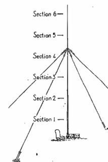
**Antenna a cannocchiale** in acciaio ramato e verniciato della lunghezza di metri 6,10 aperta. Corredata di base isolata e chiodone da fissare a terra. Il tutto pesa circa kg. 13,500. **Prezzo: L. 25.000 + 5.000 i.p.**
