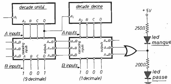
Quando A inputs ≥ B inputs, si accenderà il led di passe e viceversa. Se le cose risultassero oscure per quanto riguarda i magnitude comparators, è bene darsi una ripassatina a pagina 1068 di cq elettronica 7/74 ove la figura 8 vi spiegherà l'arcano.
