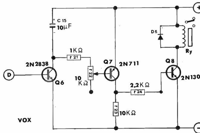
Il potenziometro R<sub>22</sub> serve per determinare il tempo per cui il relay resterà chiuso ed è regolabile da circa 0,5 sec a circa 2 sec da dopo che si è cessato di parlare davanti al micro. Il relay è da 12 V, a uno o più contatti e può essere sostituito da un reed-relay di pari tensione e con contatti adatti a reggere almeno 1,5 A.
