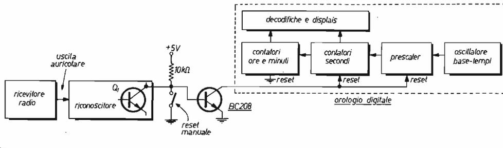
Tale schema è rappresentato in figura 6: si nota un ricevitore radio OM, il riconoscitore dei segnali orario e l'orologio digitale.
