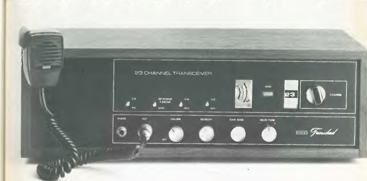
Ricetrasmettitore SBE; stazione base 23 canali quarzati, 5 Watt - mobile in legno.
