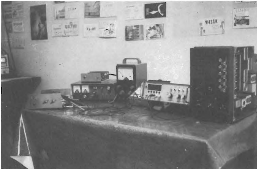
5 - « Base Station »: da sinistra a destra si notano: control box, alimentatore con sopra il converter, voltmetro elettronico, tester, frequenzimetro digitale (ci sta bene!) e BC603.
