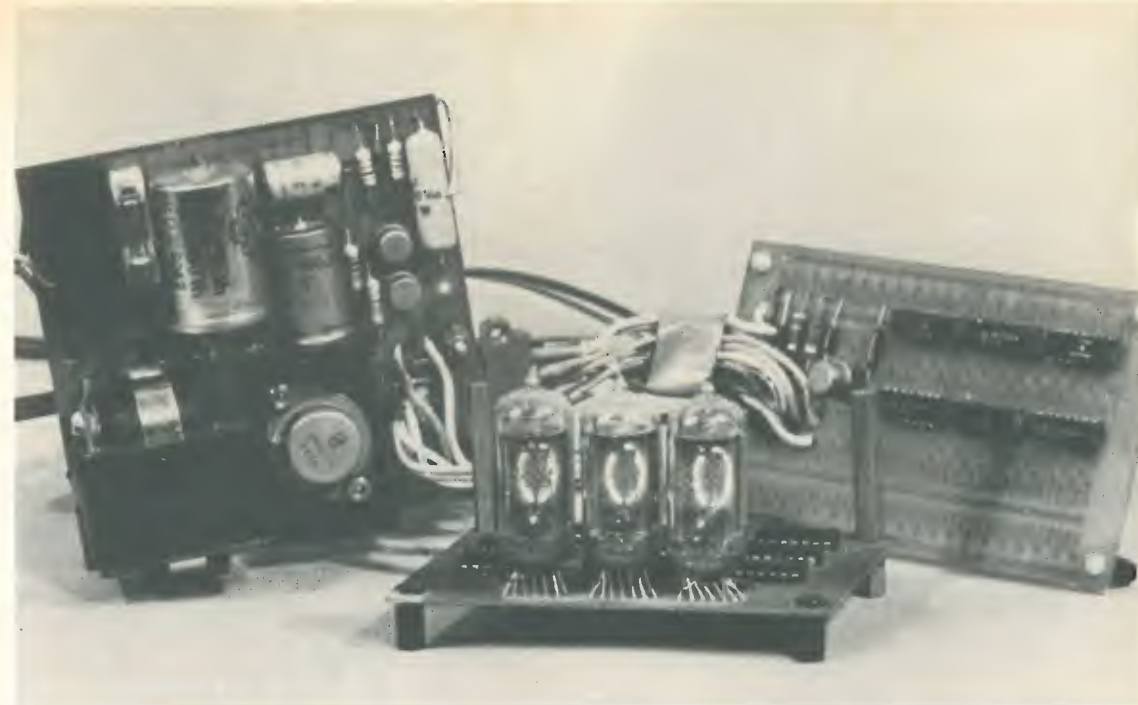
Unità di conteggio e memoria: misuratore intervalli di tempo.
