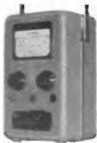
MINIVOLTMETRO « Marconi » TF899 150 mV - 500 mV - 20 V fs fino a oltre 100 Mc
