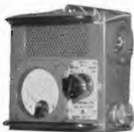
WATTMETRO CT87 RF input 25 W max, 100-156 Mc
