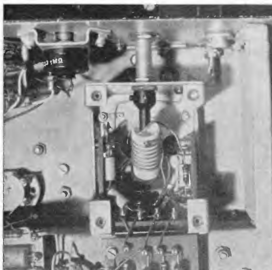
Ondametro T74: particolare dell'originale sistema adottato per realizzare la correzione della frequenza.
