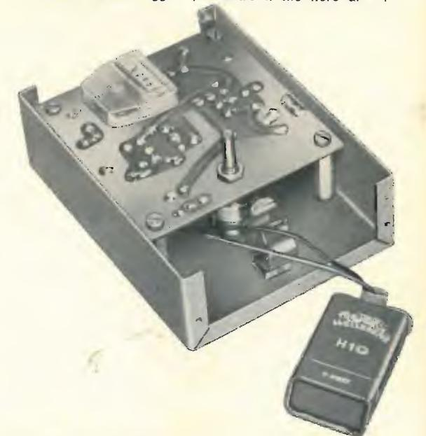
Il cablaggio dello strumento è alquanto semplice. Infatti il medesimo filo del  $\varnothing$  1 mm, oltre che da collegamento elettrico tra i terminali serve ottimamente come fissaggio dello strumento stesso. La basetta completa dei componenti va fissata nel contenitore.
