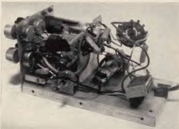
figura 2 (Vaghi) Lo zoccolo «portatubo» è fissato su due fenditure in modo da poterlo orientare (vedi foto). (visto dal lato dei collegamenti)
