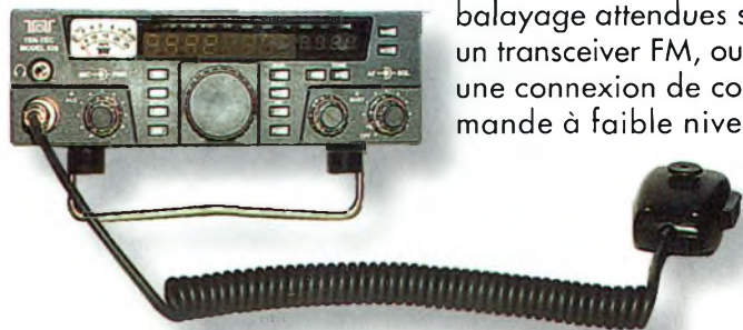
Le transceiver VHF multimode 6N2 de Ten-Tec est l'un des nouveaux transceiver présenté à Dayton en 2001. Le 6N2 opère sur les bandes des 6 et 2 mètres et c'est le premier transceiver multimode VHF avec traitement de signal numérique.
