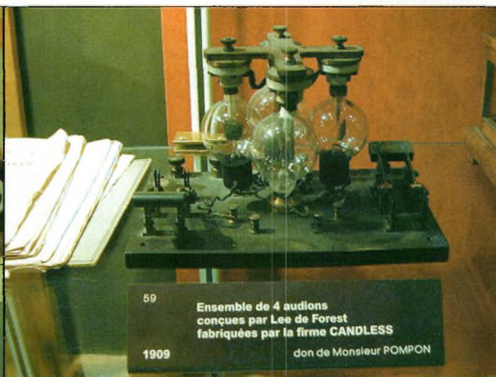
1909, l'un des premiers postes récepteurs à tubes électroniques.
