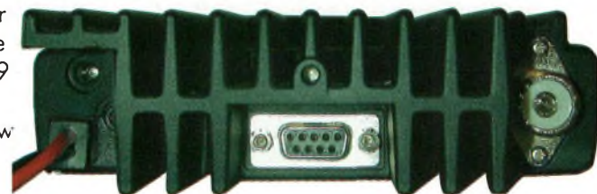
L'arrière de l'appareil, connecteur antenne, accès modem, sortie HP et alimentation.
