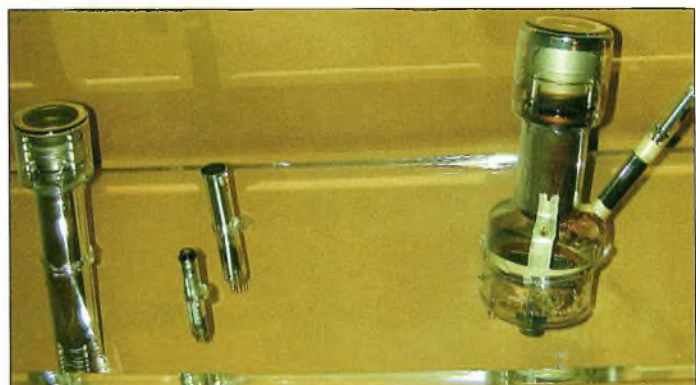
Ces tubes sont en réalité les premières générations de capteurs d'images pour la télévision.
