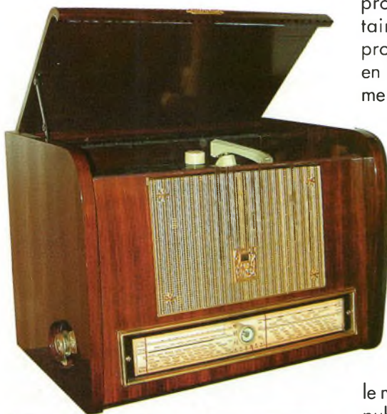
Un récepteur avec l'apparition de l'œil magique permettant de peaufiner l'accord en fréquence.
