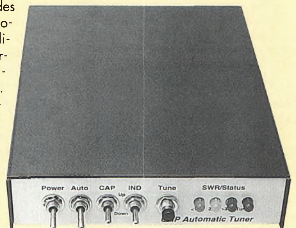
Photo D- Ce tuner d'antennes automatiques LDG autonome est l'un des nombreux appareils fabriqués pour fonctionner avec tous les types de transceivers et il rend les opérations "mains libres" très faciles. Cet appareil comprend aussi un pont SWR intégré pour la commodité.
