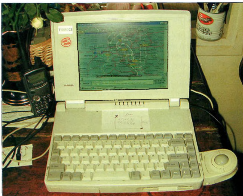
Un vieux ordinateur portable de type 486, un THD7 et c'est parti pour faire de l'APRS sur un coin de la table du salon.
