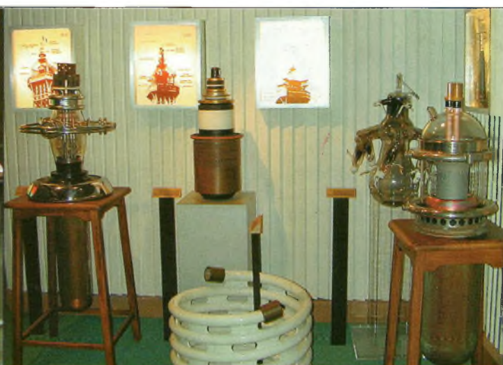
Des tubes d'émission d'époque et grosse puissance. Le refroidissement s'opérait grâce à de l'eau "bouillante".
