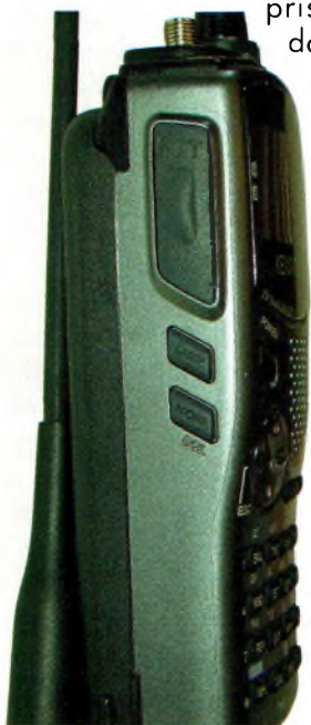
Le PTT, la lampe et le moniteur qui ouvre le silencieux.
