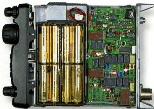
Vue intérieure du FT-817. Yaesu propose une batterie en nickel-cadmium et une place pour les piles alcalines AA. (Photo de WA6NGH)
