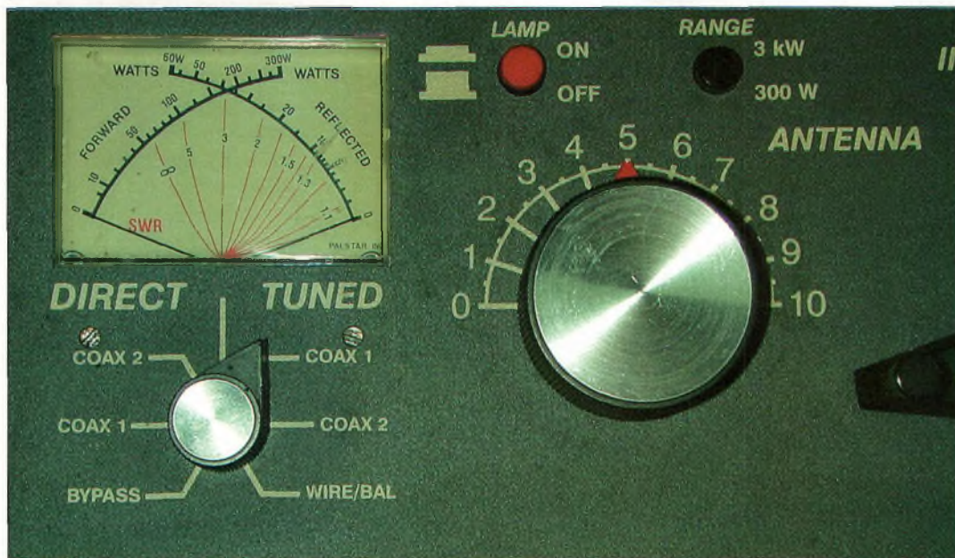
La lecture du direct et du réfléchi se fait simultanément sur un galvanomètre à aiguilles croisées.
