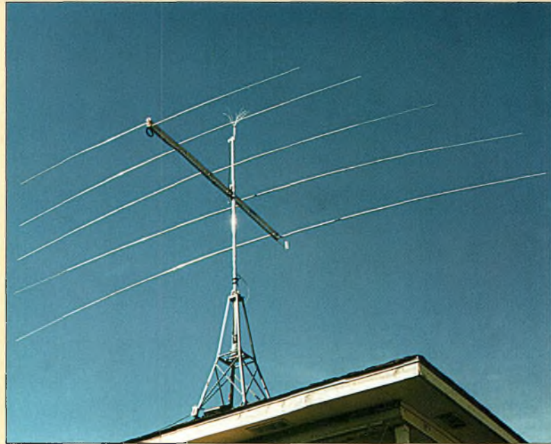
Un pylône sur le toit est un compromis acceptable quand on ne peut pas faire autrement. Un inconvénient majeur est la proximité de l'antenne et du câblage de la maison, situé juste sous le toit.
