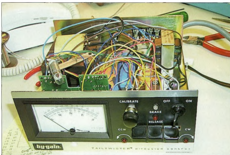
Vu du panneau avant, le seul indice de l'installation du Rotor-EZ est la LED bicolore supplémentaire sur le Brake Release LED. A l'intérieur, c'est une autre histoire. Suggestion du fabricant : pour éviter un mauvais emploi, collez une étiquette adhésive pour indiquer la présence du Rotor-EZ.
