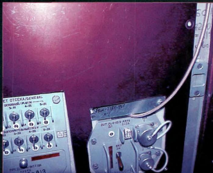
La maquette au sol du module FGB fait apparaître les câbles et connecteurs qui seront utilisés pour le trafic radioamateur. (Photo by Lou McFadin, W501D)
