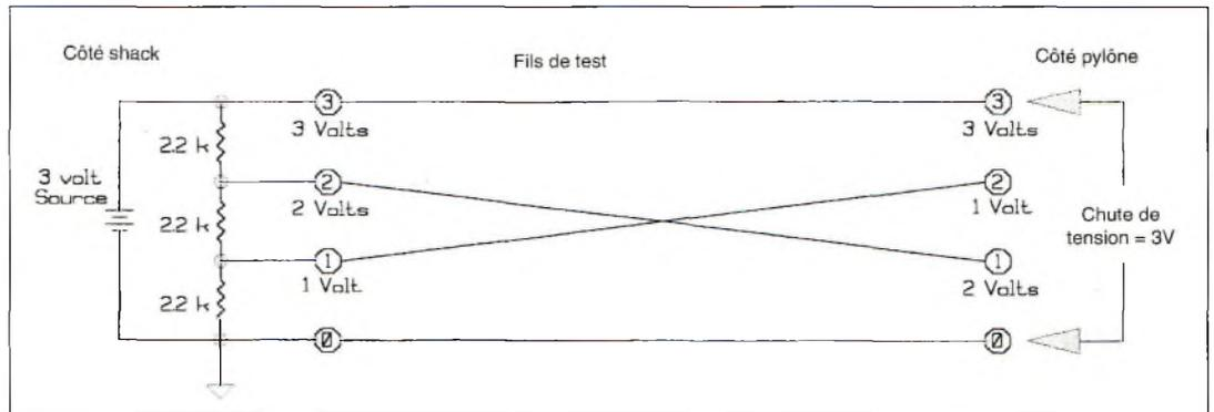
Fig. 3- Lorsque deux fils sont croisés, les tensions mesurées sont inversées ce qui permet de les différencier.
