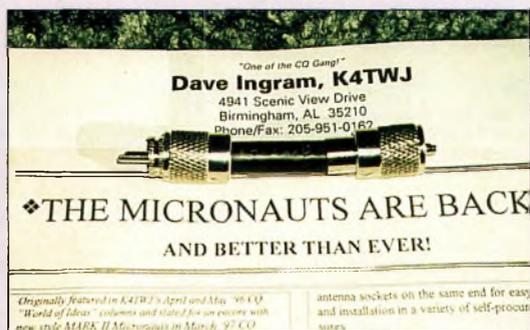
Qu'est-ce donc cet objet à l'aspect très anodin ? Un cordon "PL/PL" ? Certainement pas. Il suffit de connecter une alimentation 12 volts à une extrémité et une antenne sur l'autre, et ce petit appareil aux allures trompeuses se transforme en émetteur QRP ! La puissance est de quelques centaines de milliwatts, c'est-à-dire de quoi réaliser quelques QSO sympathiques. (Photo ©Dave Ingram, K4TWJ)
